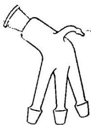
Рис. 78. «Паук» для сбора 3-х фракций конденсата при вакуум-перегонке.
