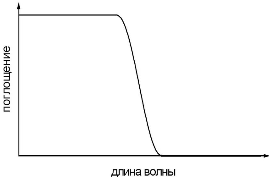
Рис.2. Спектр собственного поглощения полупроводника
