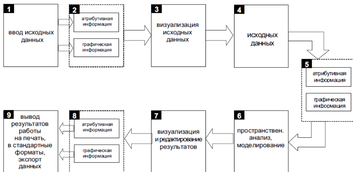
Рис. 1.1. Обобщенная схема функционирования ГИС
