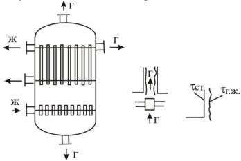
За счет значительных сил трения на межфазной поверхности пленки газ увлекает жидкость в вертикальном направлении и организуется восходящий прямоток. Если  $\tau_{\text{г.ж.}} >> \tau_{\text{ст}}$ , такой режим называется сильным взаимодействием, если наоборот, то слабым.
