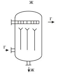
б) трубчатые абсорбер. Жидкость распределяется по внутренней поверхности контактных трубок в виде пленки и стекает вниз, газ движется в противотоке, где происходит поглощение компонента. Если в процессе абсорбции выделяется теплота, то в межтрубное пространство подается охладитель.
