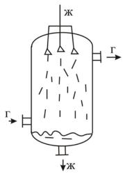
Процесс абсорбции происходит в противотоке, переход компонента из газовой фазы в жидкую происходит через межфазную поверхность капель. Эффективность процесса существенно зависит от полидисперсности и среднего размера капель.
