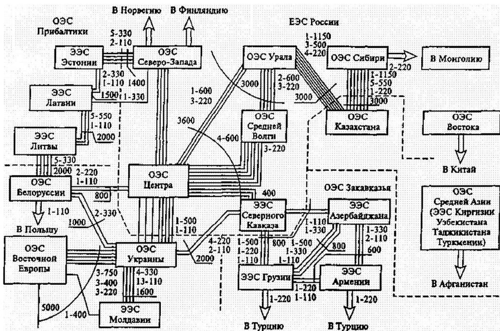
Рис. 1.1. Структура ЕЭС и схема связей высших напряжений между параллельно работающими ОЭС РФ, а также ЭЭС и ОЭС союзных государств
