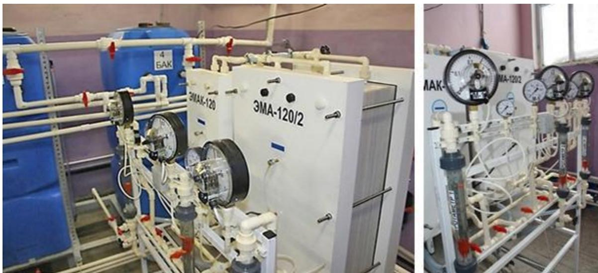
Слева: внешний вид блока электромембранных аппаратов, справа: контрольно-измерительные приборы в сборе на раме-стойке
