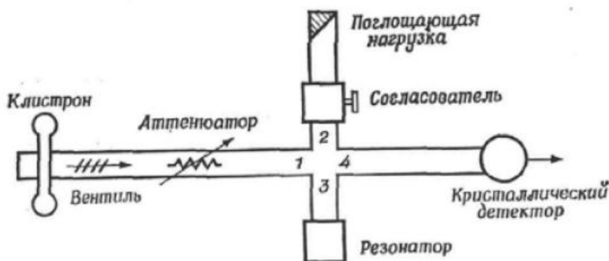
Рис. 10. Балансная схема с волноводным двойным Т-мостом
