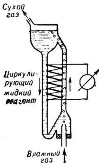
Рис. 3.8. Принцип действия влагомера, основанного на тепловом эффекте реакции сорбции
