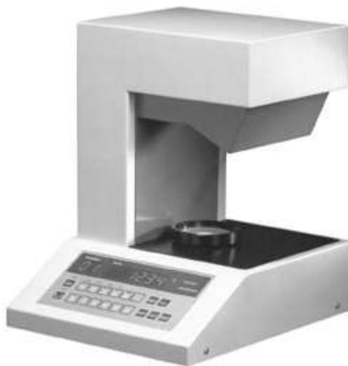
Рис. 3.4. Инфракрасный влагомер, работающий по методу отражения
