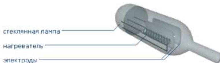
Рис.10 Ионизационный датчик вакуума
