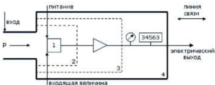
Рис. 1 Блок-схема преобразователя давления в электрический сигнал
