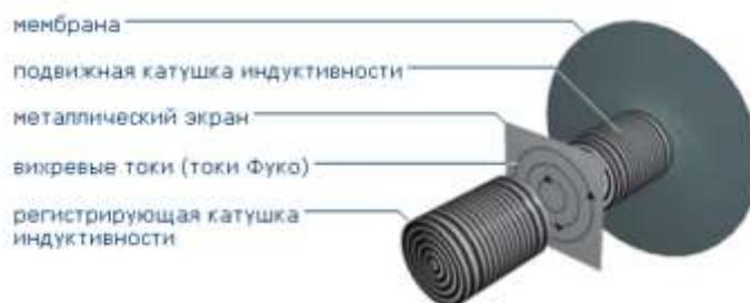
Рис. 9 Принципиальная схема индукционного преобразователя давления
