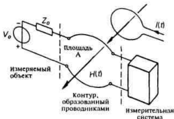
Рис. 11. Индуктивная наводка помехи на входе измерительной системы
