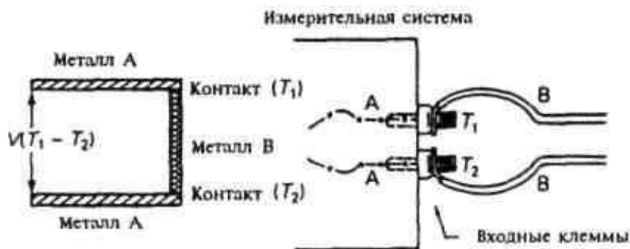
Рис. 7. Термоэлектричество в качестве аддитивной помехи в электрической системе: а - термопара, образованная двумя контактами разнородных металлов; клеммы вольтметра
