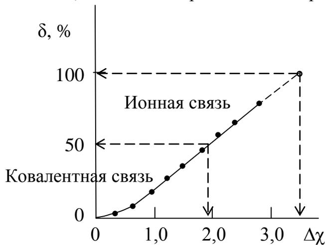
Рис. 11.1. Зависимость степени ионности связи  $\delta$  от разности электроотрицательностей  $\Delta\chi$  элементов связанных атомов.
