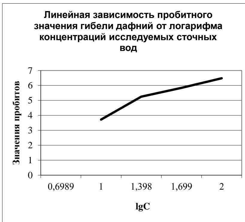
Рис. 1. Пример расчета ЛКР<sub>50</sub> и БКР<sub>10</sub> за установленный период времени
