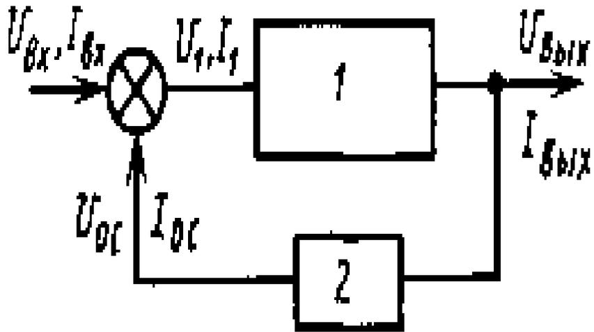
Структурная схема усилителя, охваченного обратной связью: 1-усилитель; 2-цепь обратной связи
