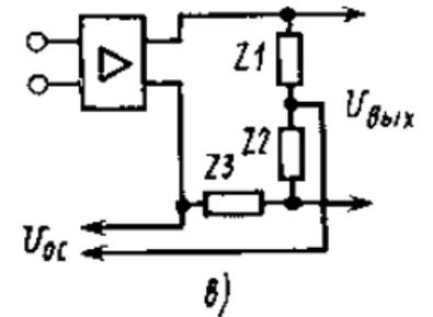
Схемы обратной связи сигнал который снимается: по напряжению (а); по току (б); комбинированно (в)
