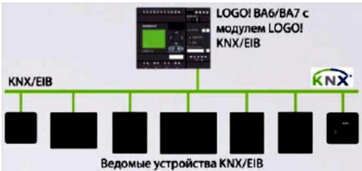
Рис. 1.26. Пример структуры сети KNX/EIB
