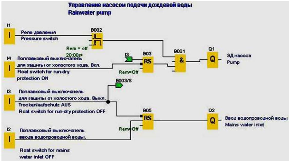
Рис. 4.18. Комментарии в программе (*Rainwaterpump.lsc*)
