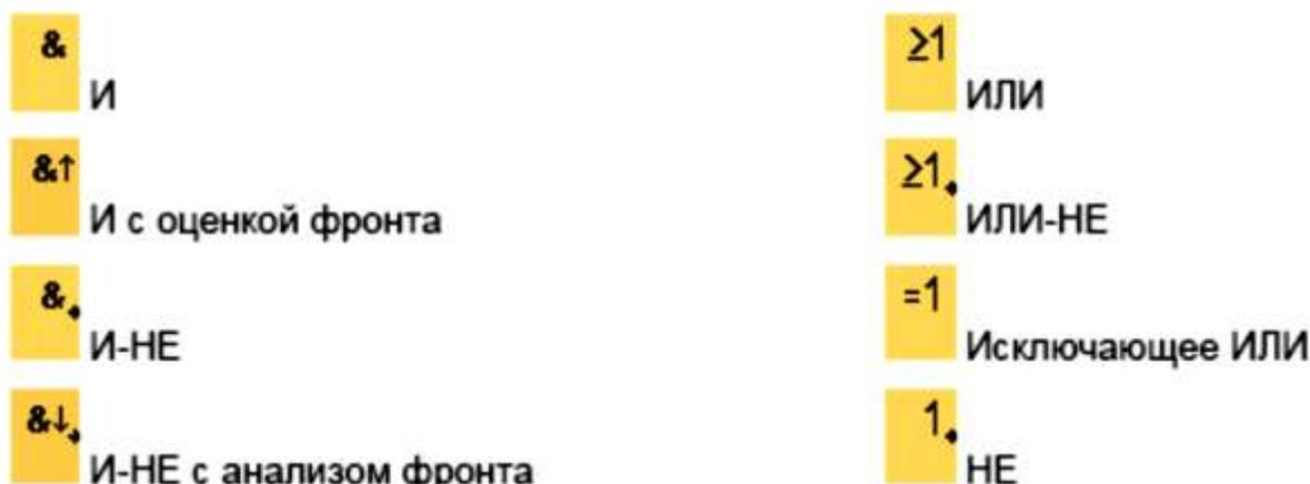
Рис. 5.1. Базовые логические функции
