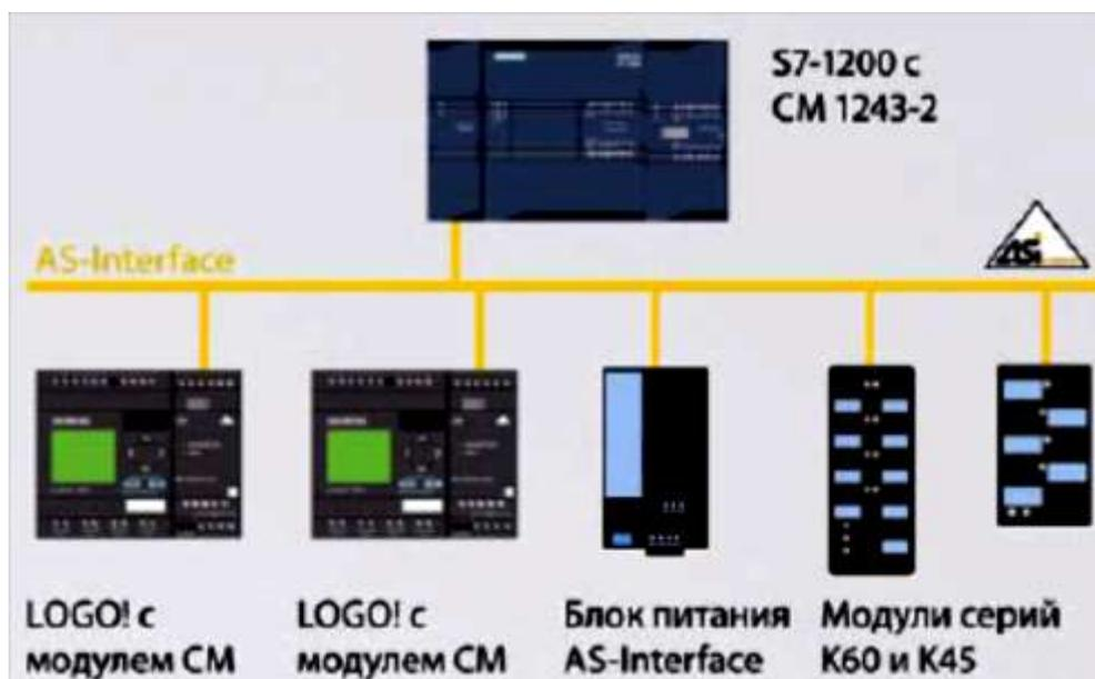
Рис. 1.25. Сеть на основе интерфейса AS-i с ведущим Master PLC S7-1200
