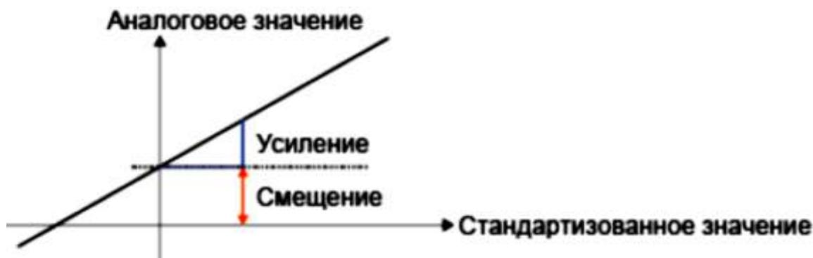
Рис. 5.55. Графическое отображение процесса усиления
