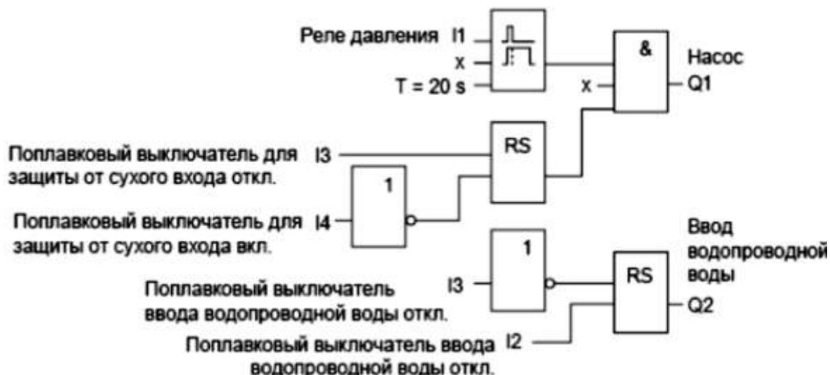
Рис. 4.8. Блок-схема программы на языке ФБД
