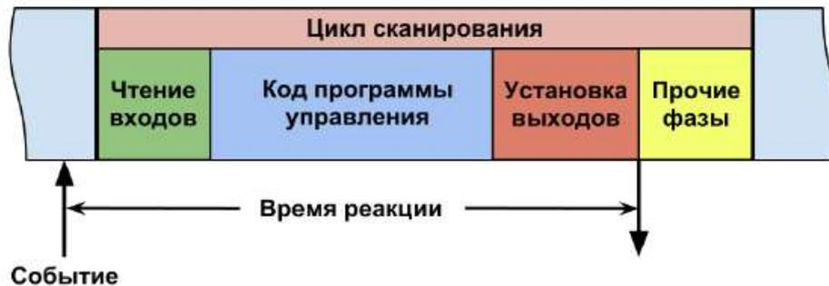
Рис. 1.3. Рабочий цикл ПЛК (PLC)
