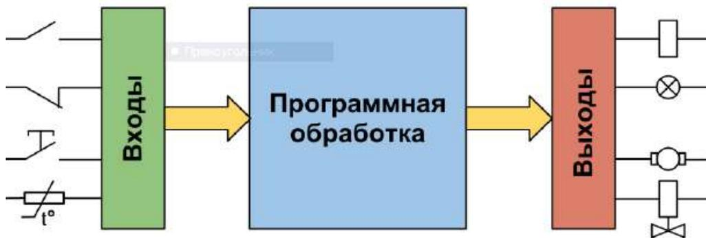
Рис. 1.2. Принцип функционирования логического контроллера
