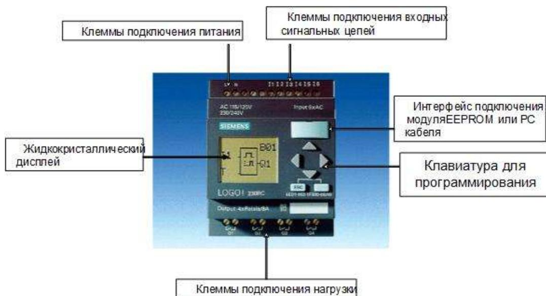
Рис. 1.10. Дизайн аппаратного интерфейса модуля ПЛК LOGO!
