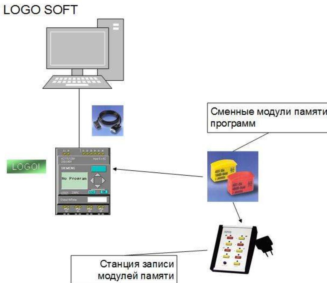
Рис. 1.4. Автоматизированное рабочее место программиста ПЛК LOGO! (Siemens)
