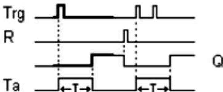
Рис. 5.13. Временная диаграмма задержки включения с сохранением
