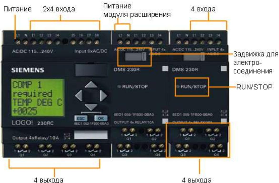
Рис. 1.7. Внешний вид ПЛК LOGO! (максимальная конфигурация: 24 дискретных входа + 8 аналоговых входов + 16 дискретных выходов)
