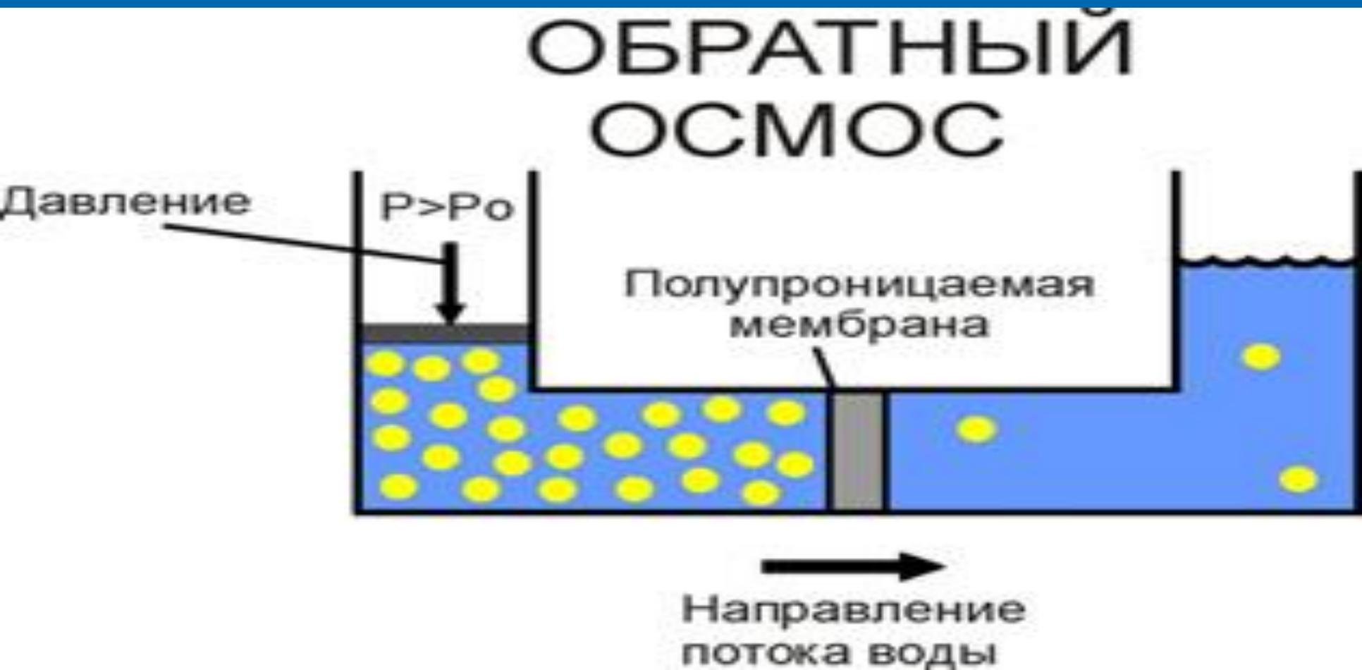
Мембрана обратного осмоса удаляет из воды органические вещества, вирусы, бактерии. В то же время, мембрана пропускает растворенные в воде кислород и другие газы, определяющие ее вкус. В результате, на выходе системы получается свежая, вкусная, чистая вода, не требующая кипячения.
