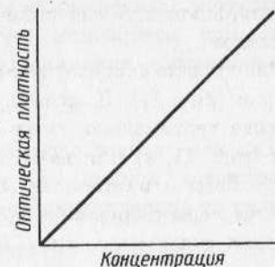
Рис. 13. Зависимость оптической плотности раствора от его концентрации (калибровочная кривая)
