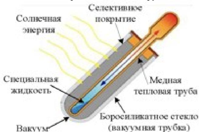
Рисунок 10 - Схема работы тепловой трубки
