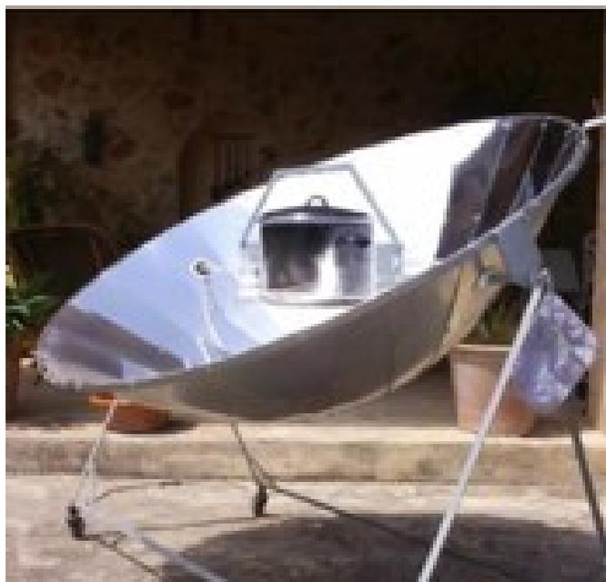
Рисунок 22 - Солнечная печь с параболическим концентратором
