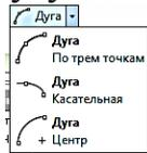
«Дуга по трем точкам» и укажем последовательно первую точку на нижней дуге диаметром 30 мм, а вторую на окружности диаметром 48 мм. Третья точка задается таким образом, чтобы сформировать выпуклость в соответствии с заданием, а в окошке задается величина радиуса сопряжения (рис. 1.9).
