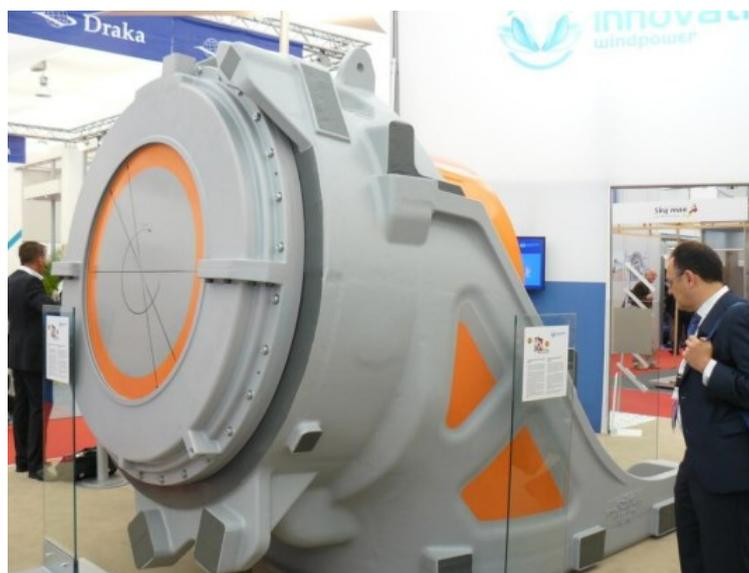
Рис. 2.12 Каркас моноблока ВЭА
