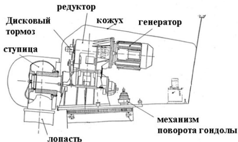
Рис. 2.11 Компоновка ВЭА с интегрированной силовой магистралью
