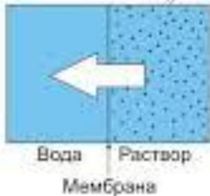
При обратном осмосе вода под давлением, большим осмотическому и создаваемого напором, проходит через полупроницаемую мембрану, и растворенные вещества задерживаются.
