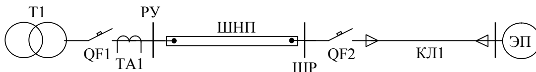
Рис.1.15. Схема электроснабжения цеховой сети
