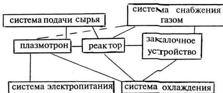
Рис. 8.6. Блок-схема плазмохимической установки
