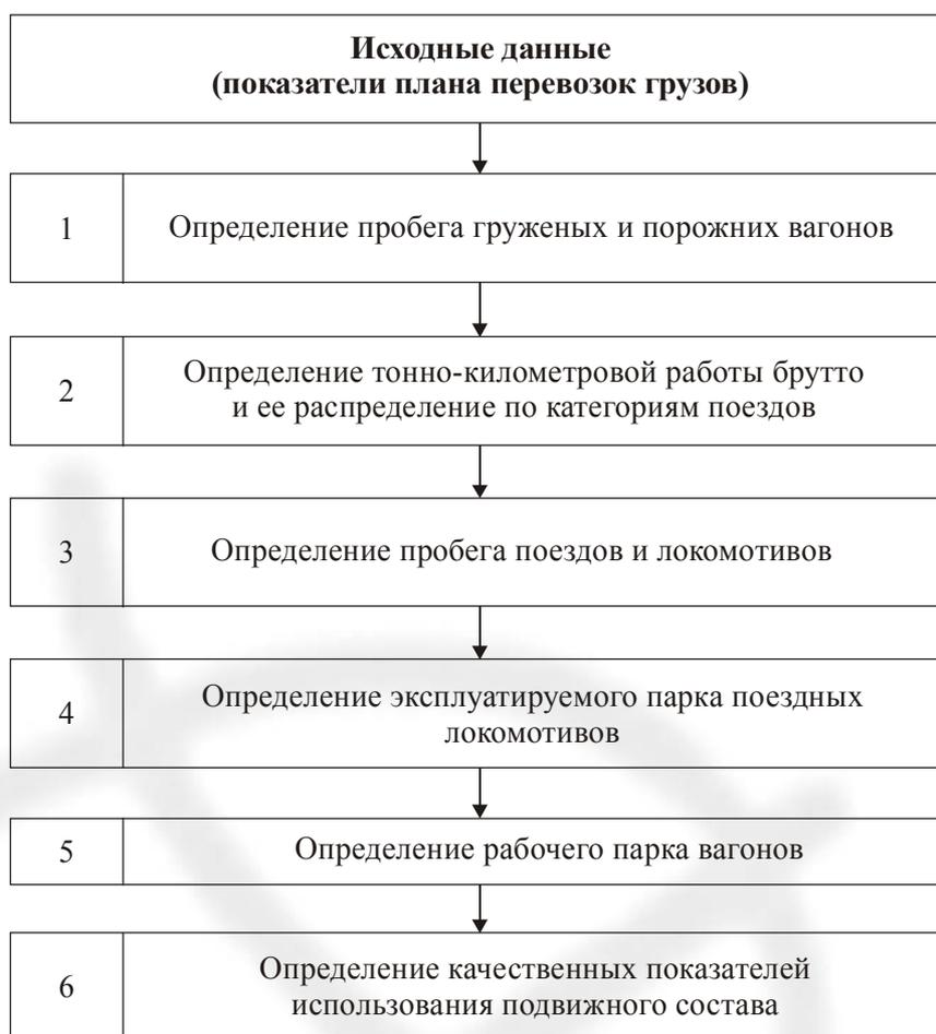
Рис. 21.1. Технологическая схема расчета показателей плана эксплуатационной работы подвижного состава
