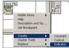
мыши, выбираем **Create >> Indicator**. При этом на интерфейсной панели появится его графический эквивалент.
