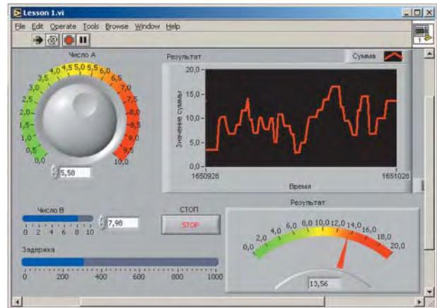
Во время работы программы попробуйте изменить положение ползунка регулятора задержки. Видим, что так можно управлять скоростью отображения результата "вручную".
