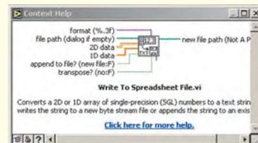
Так как кроме входа "ввод одномерного массива" (1D data), другие входы (формат, путь и т.п.) нами не подсоединялись, то LabVIEW сформирует следующую последовательность действий:
