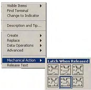
и нажать правую кнопку мыши. В выпадающем меню выбрать **Mechanical Action**, а в нем **Latch When Released**. Такую же операцию можно проделать и для кнопки останова. Для освоения различных режимов работы, самостоятельно поэкспериментируйте при запуске и выполнении программы.
