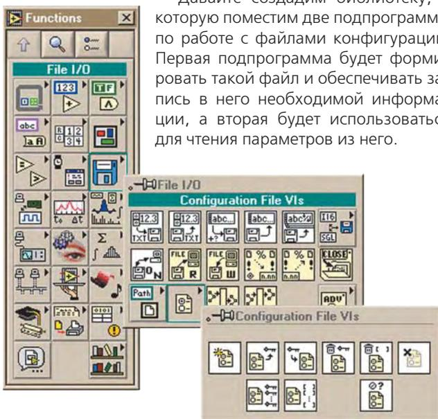
Представим себе, что мы работаем с платой многоканального АЦП и хотим создать файл отчета, который будет содержать интересующие нас параметры: количество каналов аналогового ввода, номера каналов, частоту дискретизации, количество регистрируемых отсчетов или интервал времени наблюдения, рабочие диапазоны или коэффициенты усиления, и просто текстовые замечания, а может быть что-то еще.
