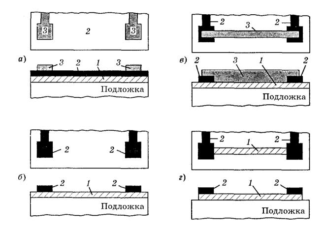
Рис. 27. Получение тонкопленочных резисторов методом фотолитографии: a — фоторезистная маска (3) под рисунок проводящего слоя;  $\delta$  — готовый рисунок проводящего слоя (2);  $\epsilon$  — фоторезистная маска (3) под рисунок резистивного слоя;  $\epsilon$  — готовый резистор с проводящими выводами
