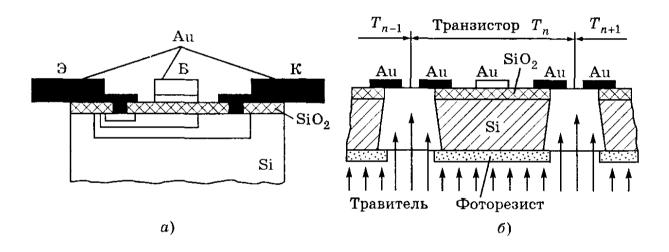
Рис. 29. Бескорпусные транзисторы с балочными выводами: a — транзистор с балочными выводами;  $\delta$  — получение балок и разделение транзисторов на пластине толщины 200-300 мкм до 50 мкм. По окончании травления клей растворяют и разделенные кристаллы отпадают от стекла.
