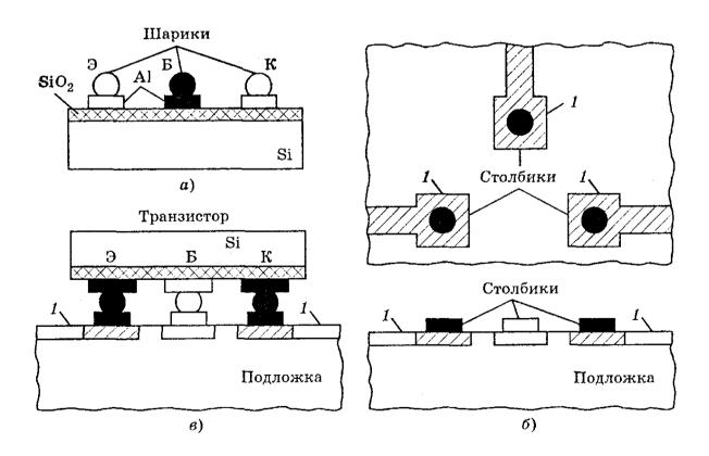
Рис. 28. Монтаж бескорпусных транзисторов с шариковыми выводами:
