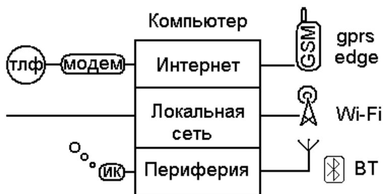
Рис. х. Сетевые и беспроводные подключения компьютера
