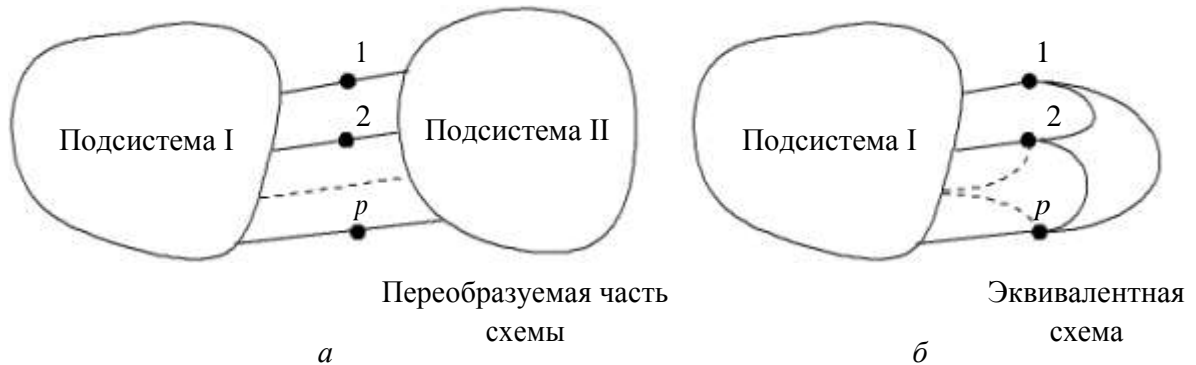
Рис. 3.12. Условное изображение ЭЭС с эквивалентизируемой частью: a – до эквивалентирования; б – после эквивалентирования
