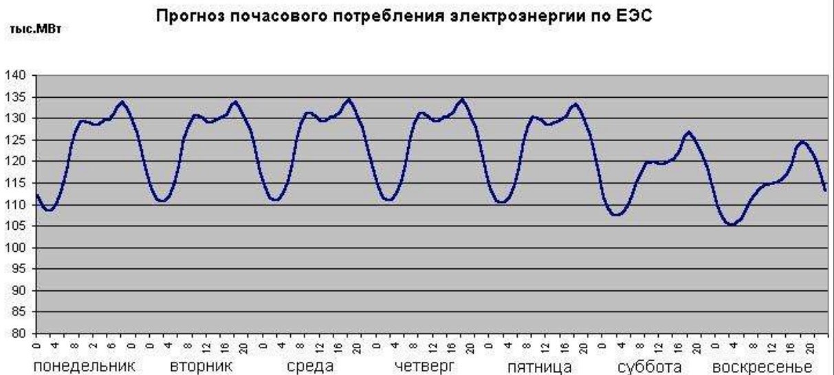
Рис. 5.20. Недельный график мощности нагрузки ЕЭС РФ
