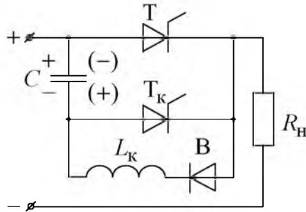
Рис. 4.14. Коммутационный узел на основе коммутационного конденсатора и дросселя
