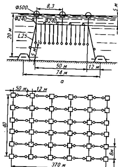
Рис.2 Секции штормоустойчивой конструкции для выращивания водорослей:
