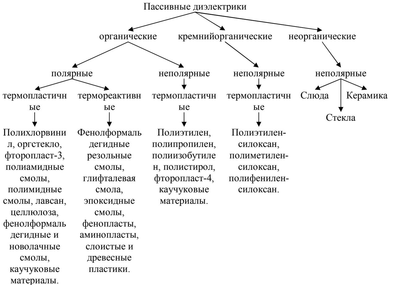
Рис. 3. Классификация пассивных диэлектриков
