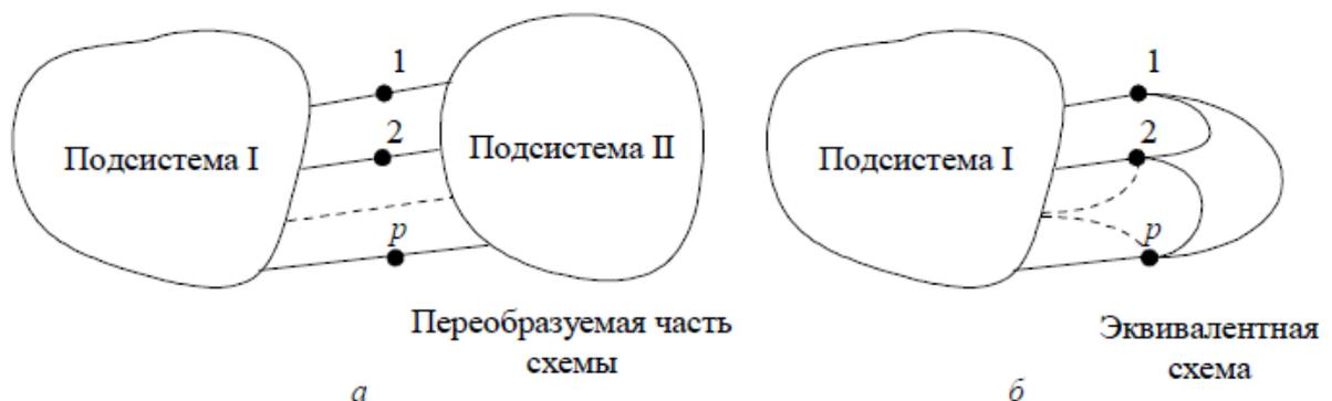
Рис. 3.12. Условное изображение ЭЭС с эквивалентируемой частью:
