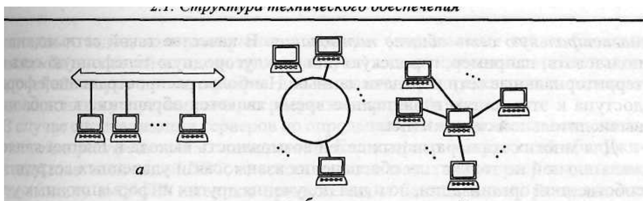
Рис.2 Варианты топологии локальных вычислительных сетей: а — шинная; б — кольцевая; в — звездная
