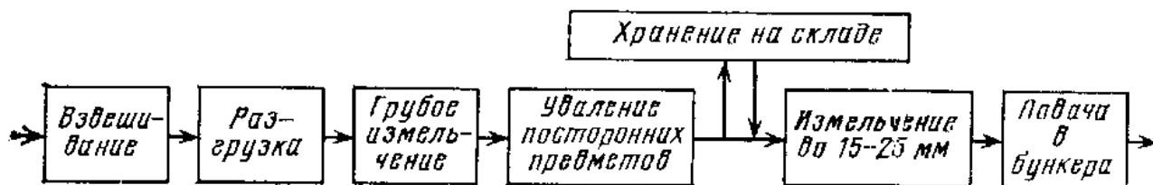
Рис.2.9. Структурная схема переработки твердого топлива на электростанциях.
