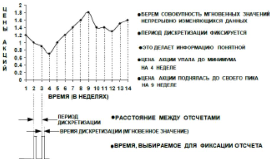
Рис. 1. Пример дискретизации
