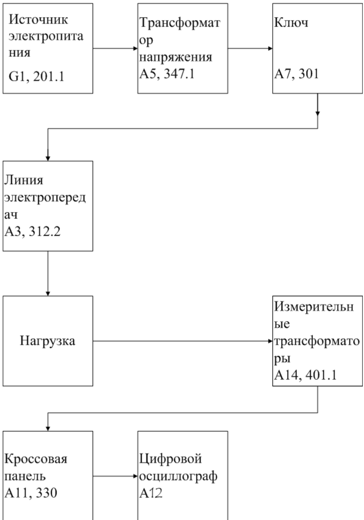
Рис.1 Блок-схема электрических соединений при выполнении лабораторной работы
