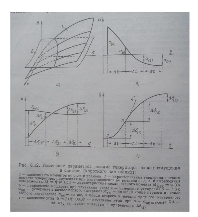
При расчетах относительного движения, происходящего со скоростью, много меньшей синхронной, упрощенно принимаем, что мощность численно равна моменту, записывая  $^1$
