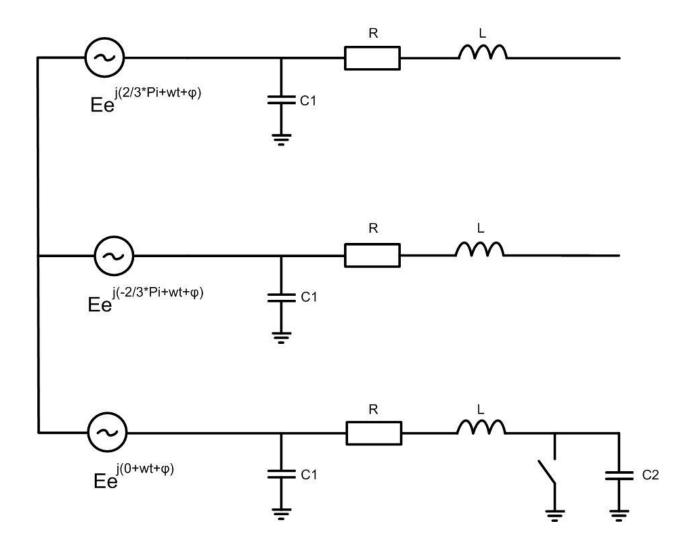
Рис.2.10. Схема замещения ЛЭП с изолированной нейтралью без нагрузки.
