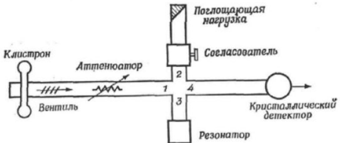
Рис. 10. Балансная схема с волноводным двойным Т-мостом
