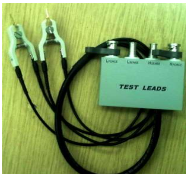
Рис. 2. Измерительный кабель LCR-06 и длинные кабели со стандартными разъемами и концевыми прищепками типа «крокодил»
