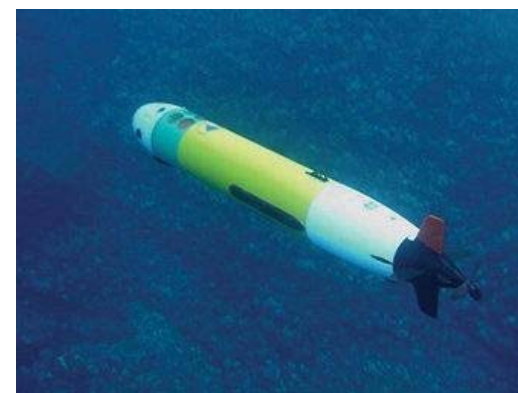
Подводный робот REMUS 100 (Hydroid) создано 200 экз.
