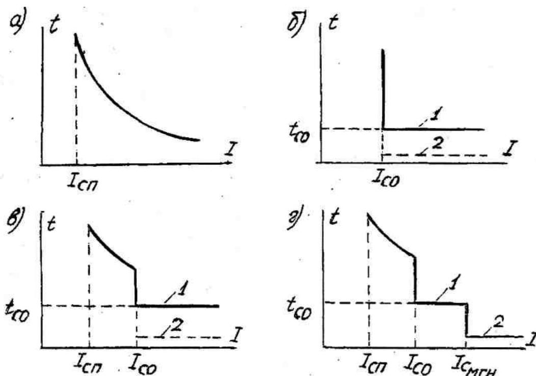
Рис. 10.3. Защитные характеристики автоматических выключателей:
