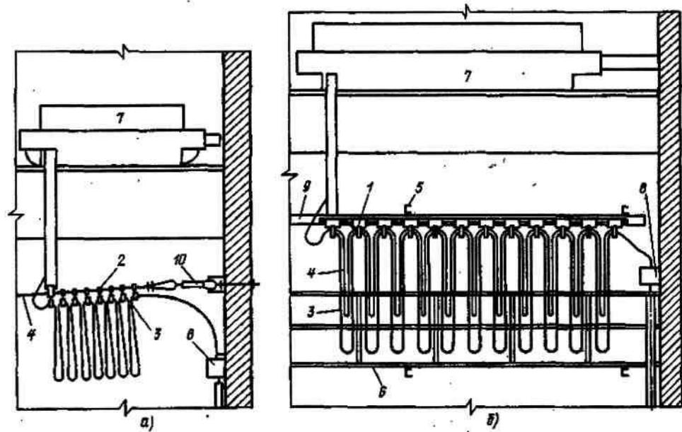
Рис. 10.2. Питание передвижных механизмов гибким кабелем:
