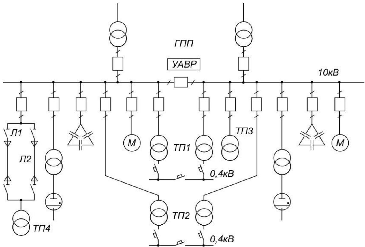
Рис. 1. Одноступенчатая радиальная схема
