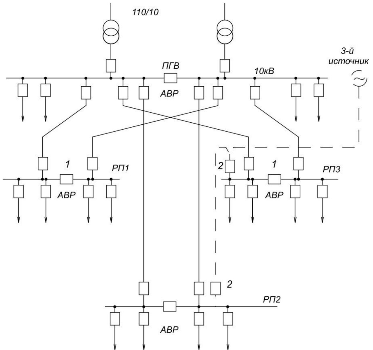
Рис. 5. Схема электроснабжения при наличии особых групп электроприемников
