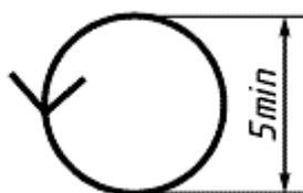
Рис. 5.20. Условное графическое обозначение «повернуто»
