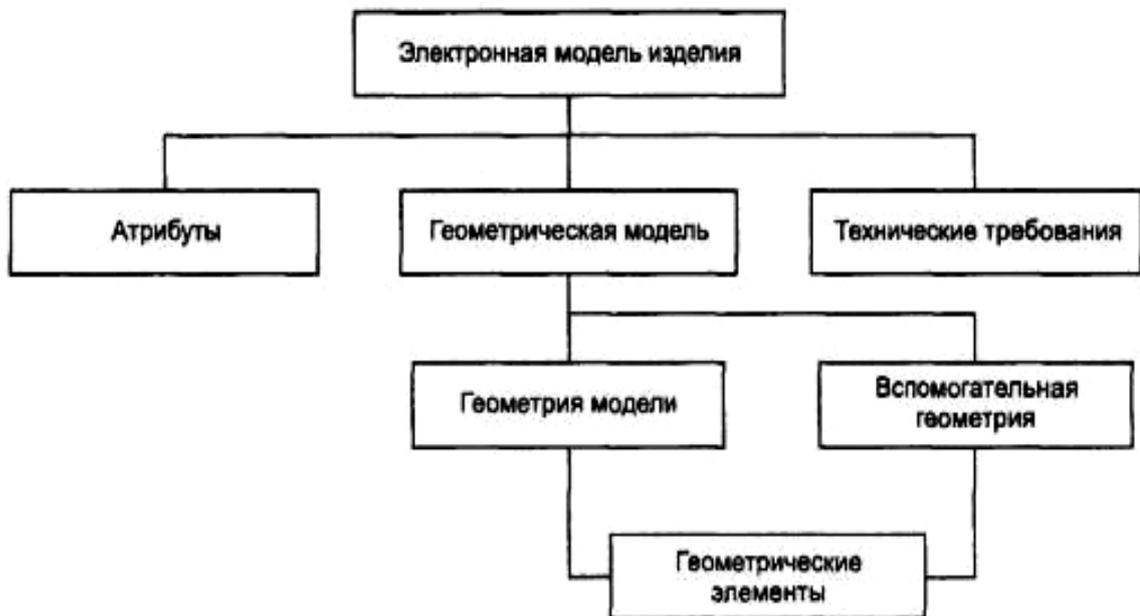
Рис. 6.1. Схематический состав ЭМИ
