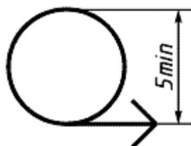
Рис. 5.21. Условное графическое обозначение «развернуто»
