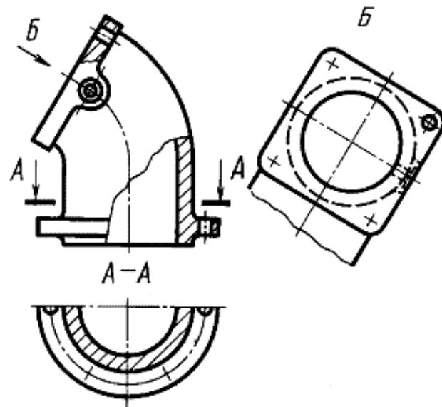
Рис. 1.5. Изображение и обозначение дополнительного вида
