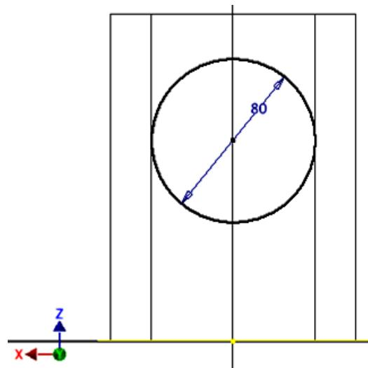
Рис. 7.12. Построение окружности диаметром 80 мм
