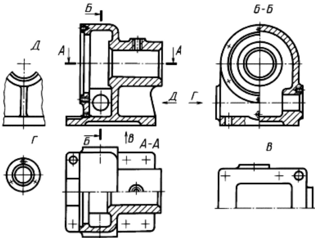
Рис. 1.9. Изображение и обозначение местного вида
