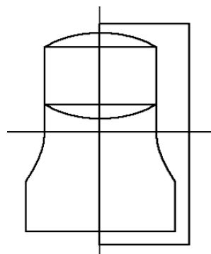
Рис. 7.33. Построение прямоугольного контура командой «Прямоугольник» на области создаваемого разреза
