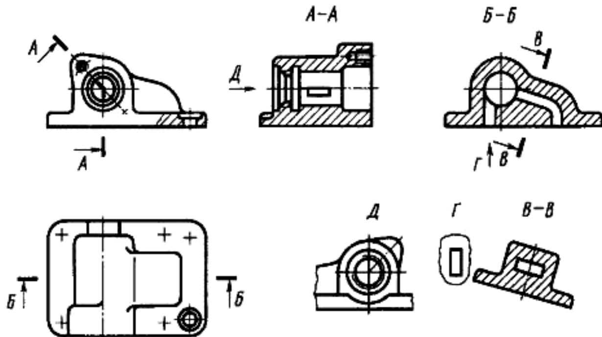
Рис. 1.4. Обозначение видов вне проекционной связи с главным изображением
