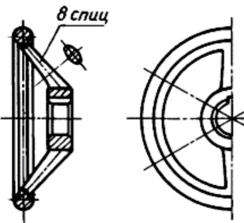
Рис. 5.2. Изображение части предмета с указанием количества и расположения его элементов
