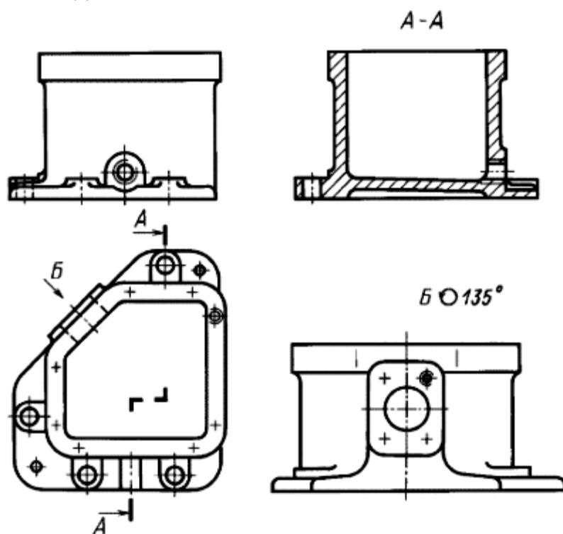
Рис. 1.8. Обозначение дополнительного вида со знаком «поворнуто»
