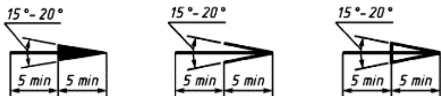
Рис. 1.10. Изображение и размеры стрелок на чертеже
