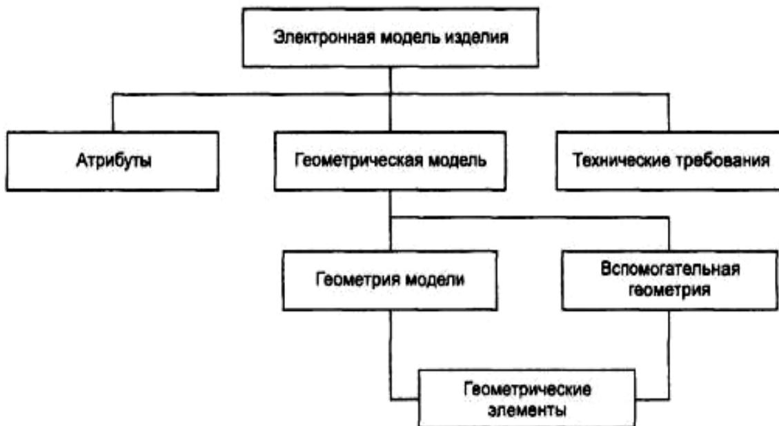
Рис. 6.1. Схематический состав ЭМИ
