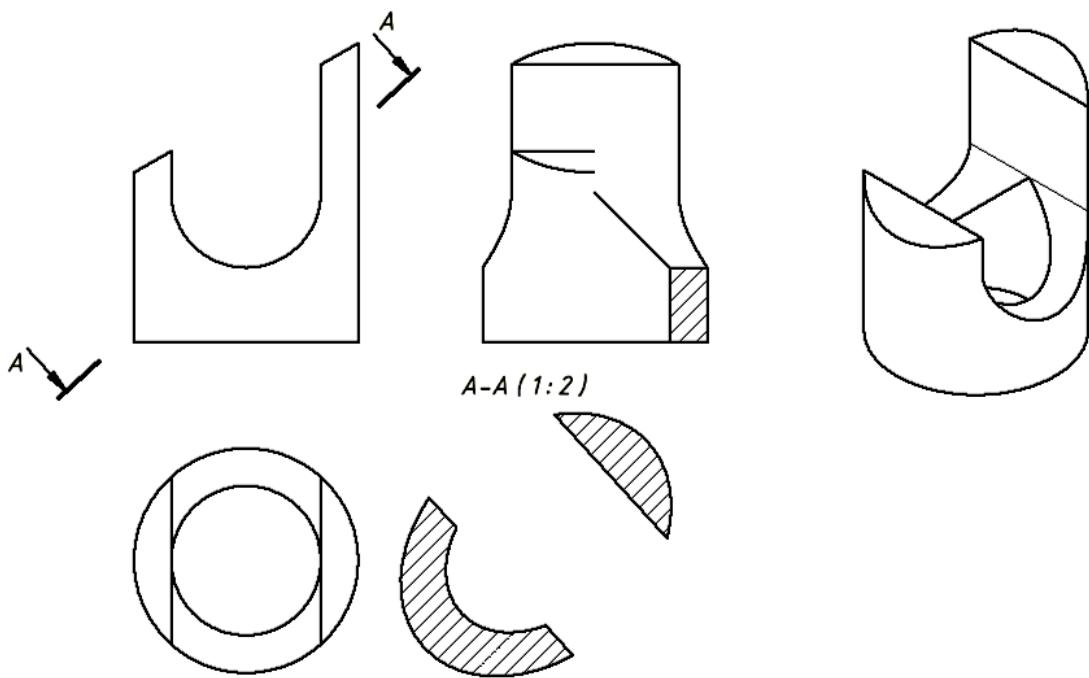
Рис. 7.42. Изображение сечения на чертеже
