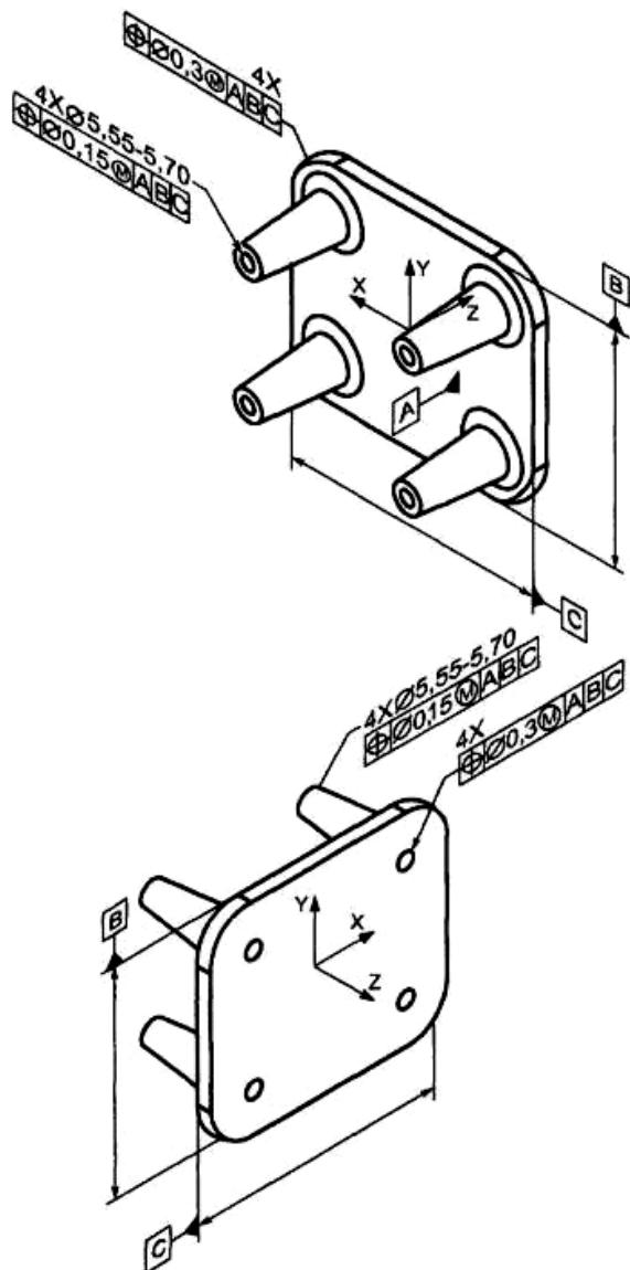
Рис. 6.2. Пример отображения ПОУ
