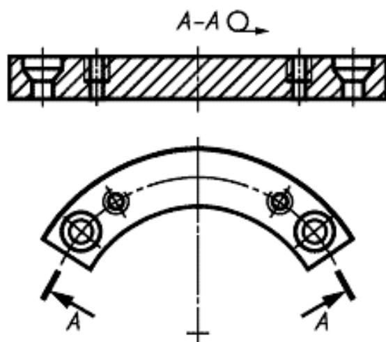
Рис. 3.2. Сечение цилиндрической поверхностью
