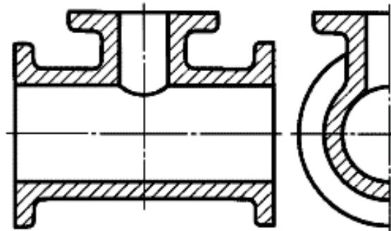
Рис. 5.4. Упрощенное изображение разреза на виде слева
