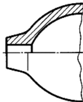
Рис. 5.7. Условное изображение плавного перехода от одной поверхности к другой при совмещении вида и разреза
