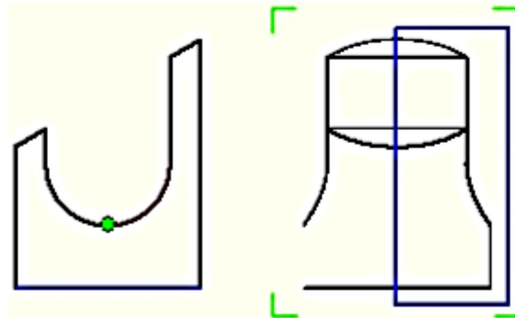
Рис. 7.35. Указание точек на главном виде на линии плоскости разреза
