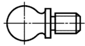
Рис. 5.9. Плавный переход от одной поверхности к другой допускается не показывать
