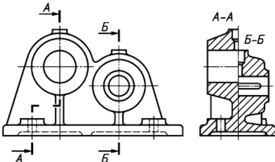
Рис. 5.19. Совмещение разрезов на виде слева
