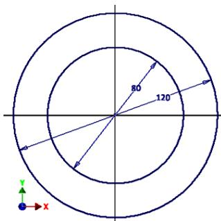
Рис. 7.50. Построение окружностей диаметрами 120 мм и 80 мм
