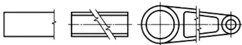
Рис. 5.12. Изображение вида предмета с разрывом сплошной тонкой линией с изломом
