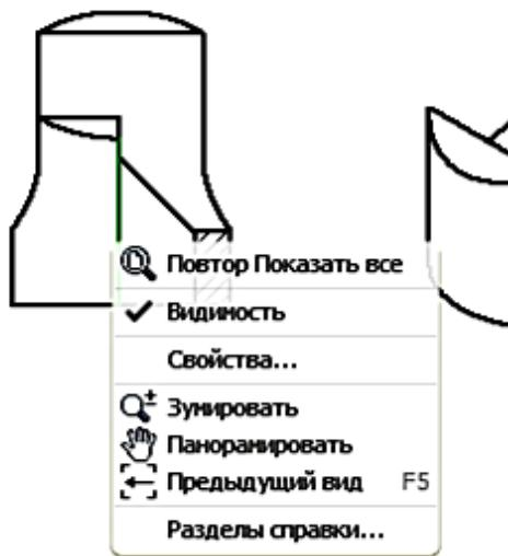
Рис. 7.37. Удаление линии разреза при помощи команды «Видимость». Если линия состоит из нескольких фрагментов, то повторите процедуру необходимое количество раз (рис.7.38).
