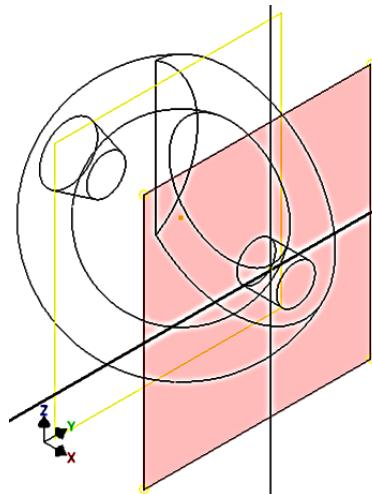
Рис. 7.65. Построение плоскости для базовой окружности
