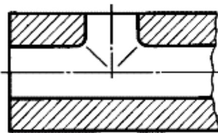
Рис. 5.6. Условное изображение плавного перехода от одной поверхности к другой в разрезе
