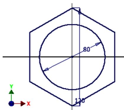
Рис.7.28. Построение окружности диаметром 80 мм в шестиугольнике
