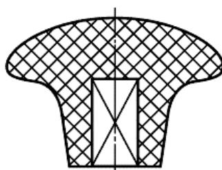
Рис. 5.11. Изображение плоских поверхностей предмета
