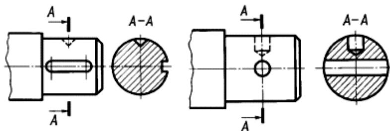
Рис. 3.15. Изображение сечения отверстий и углублений
