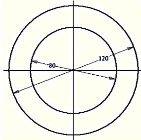
Рис. 7.2. Построение окружностей диаметром 80 мм и 120 мм
