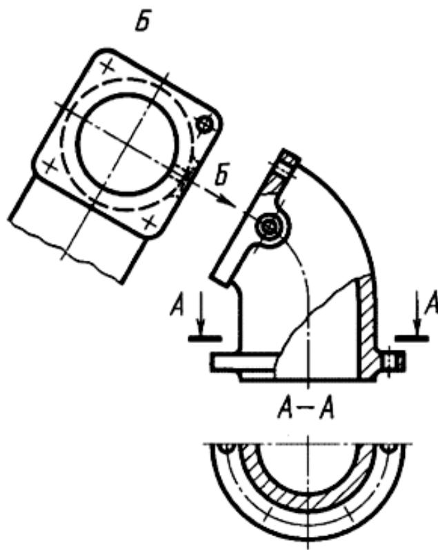
Рис. 1.6. Изображение и обозначение дополнительного вида
