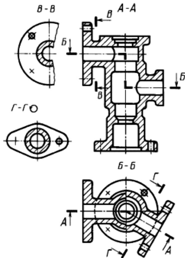
Рис. 2.3. Изображение и обозначение разрезов
