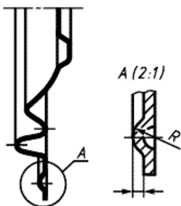
Рис. 4.1. Изображение и обозначение выносного элемента
