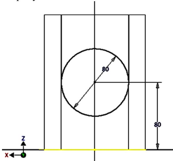
Рис. 7.14. Построение вертикальных отрезков
