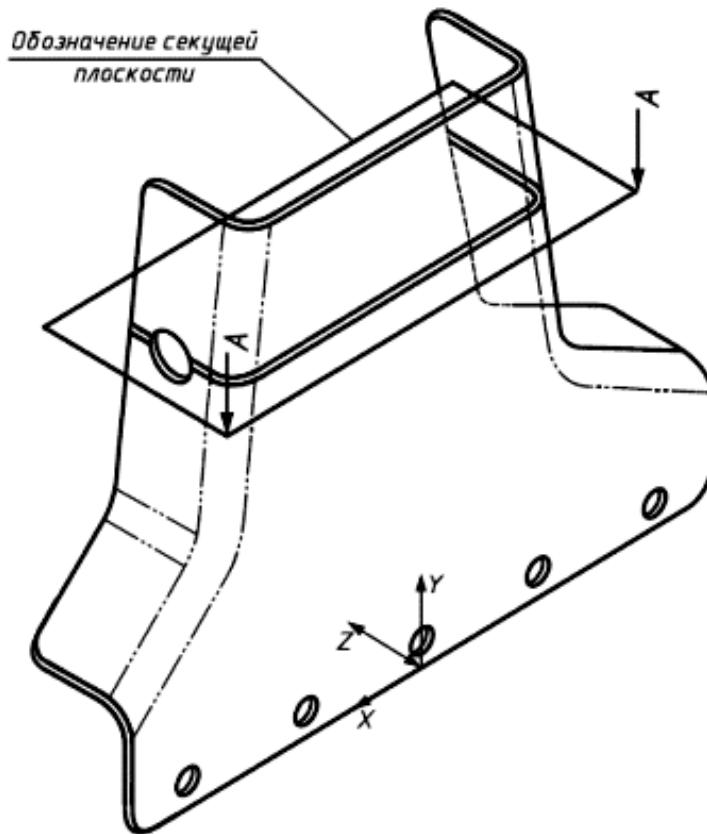
Рис. 3.6. Наложенные сечения в электронных моделях
