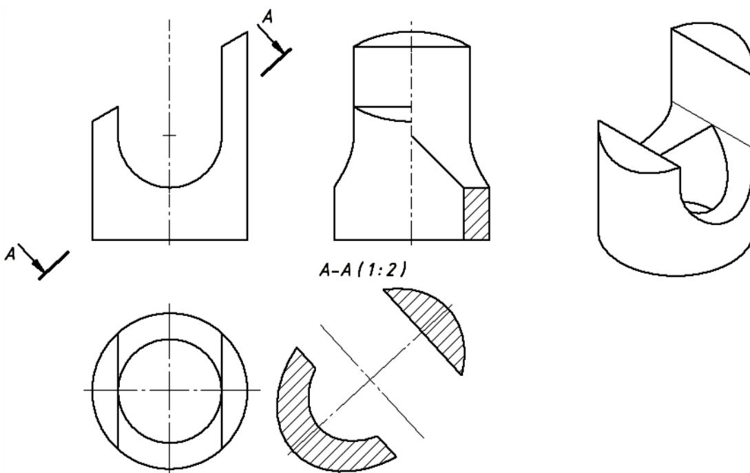
Рис. 7.43. Нанесение осевых и центровых линий
