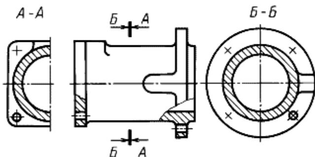
Рис. 2.5. Поперечный разрез
