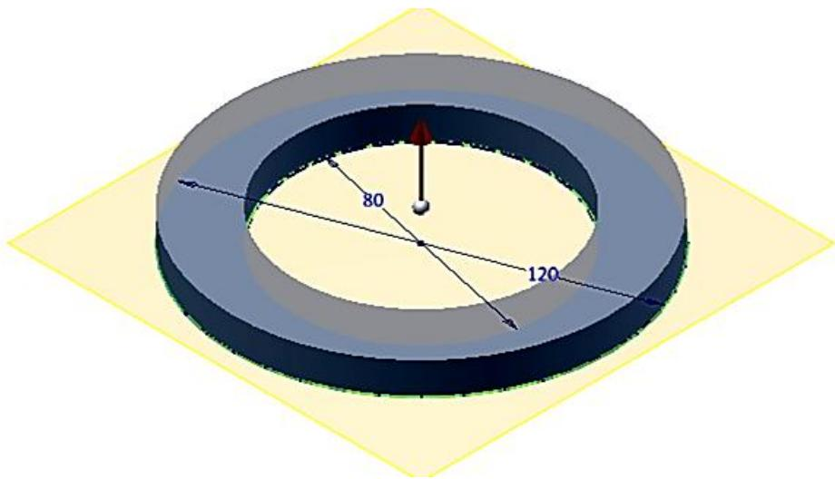
Рис. 7.6. Изображение цилиндра высотой 10 мм
