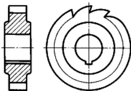
Рис. 5.1. Упрощенное изображение одинаковых элементов
