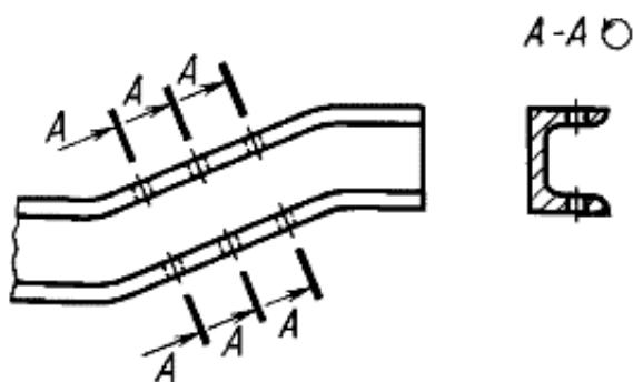
Рис. 3.12. Обозначение и изображение одинаковых сечений со знаком «поворнуто»
