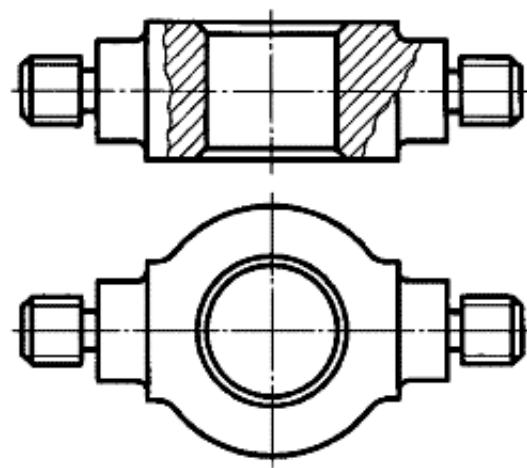
Рис. 2.11. Соединение части вида с разрезом, разделенных волнистой линией
