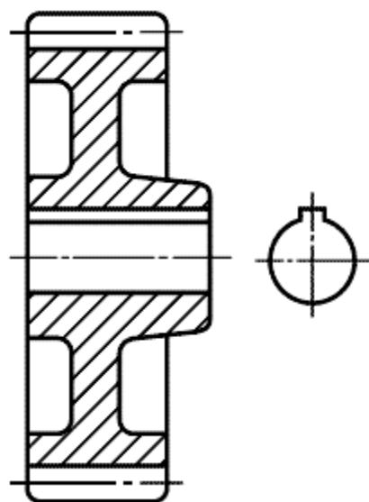
Рис. 5.18. Упрощения при изображении отверстий в ступицах зубчатых колес, шкивов и шпоночных пазов
