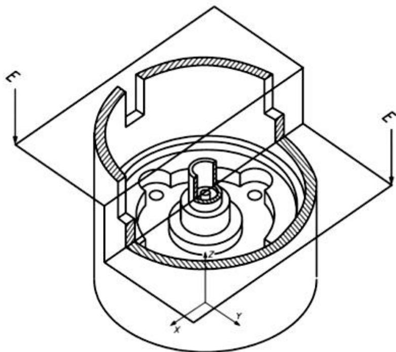
Рис. 3.10. Расположение стрелок сечения для электронной модели
