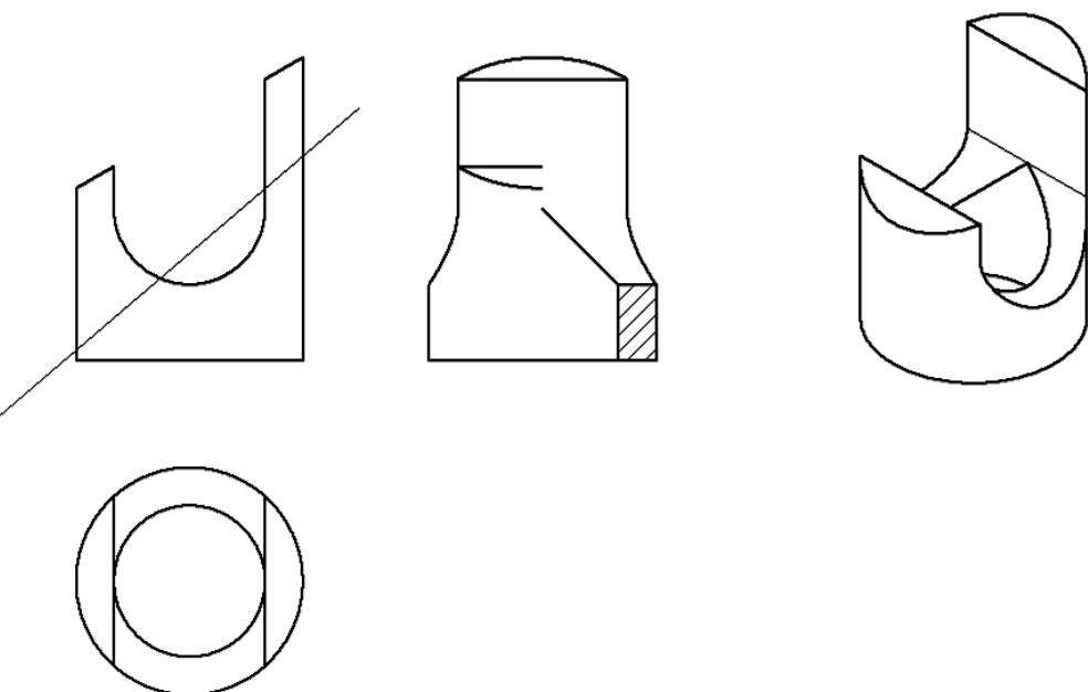
Рис. 7.39. Построение двух точек для задания линии сечения
