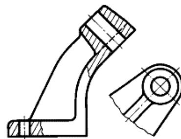
Рис. 1.7. Изображение и обозначение дополнительного вида в проекционной связи
