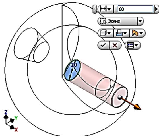
Рис. 7.63. Команды для построения цилиндрического выреза
