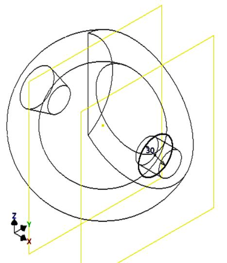
Рис. 7.66. Построение окружности диаметром 30 мм
