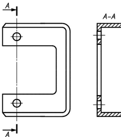
Рис. 3.16. Сечение отдельных самостоятельных частей
