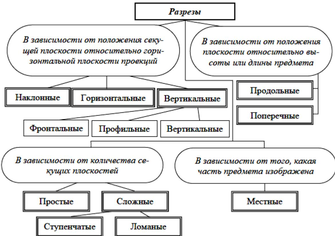
Рис. 2.2. Классификация разрезов
