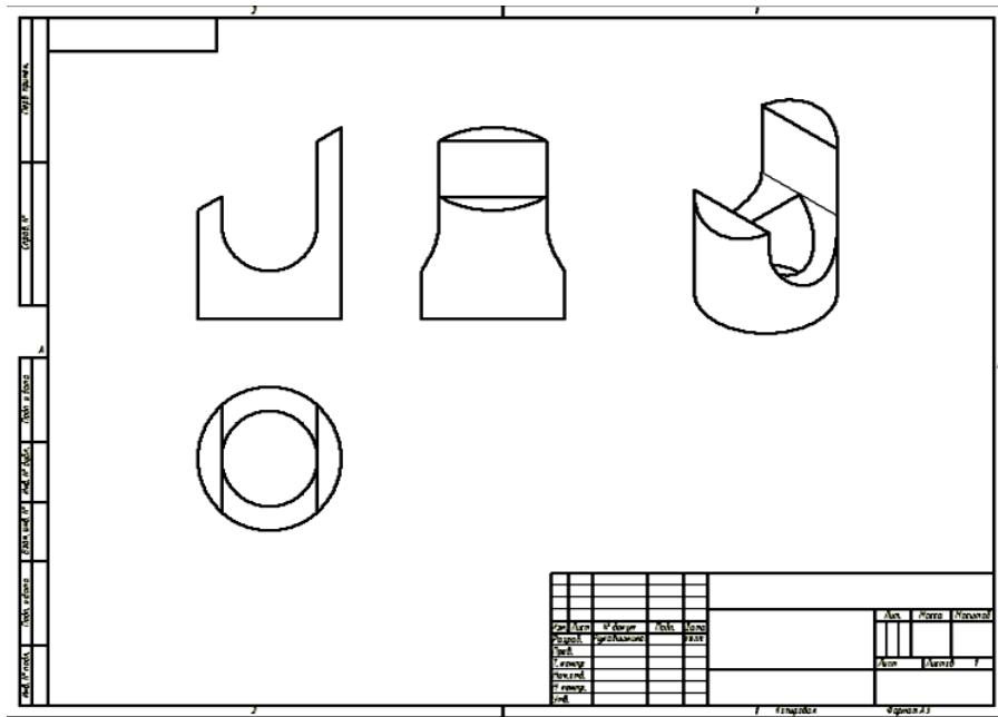
Рис. 7.32. Изображение видов и аксонометрической проекции на чертеже
