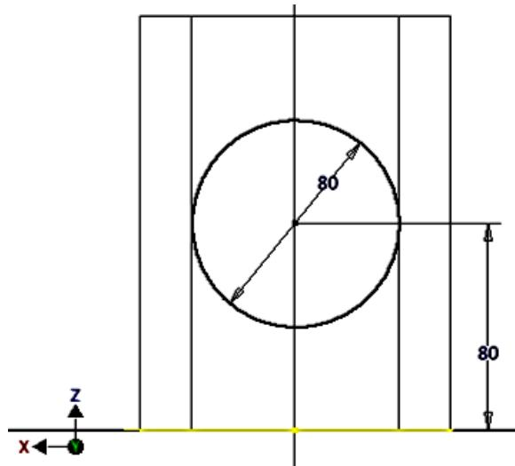
Рис. 7.13. Построение окружности на высоте 80 мм
