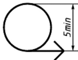
Рис. 5.21. Условное графическое обозначение «развернуто»
