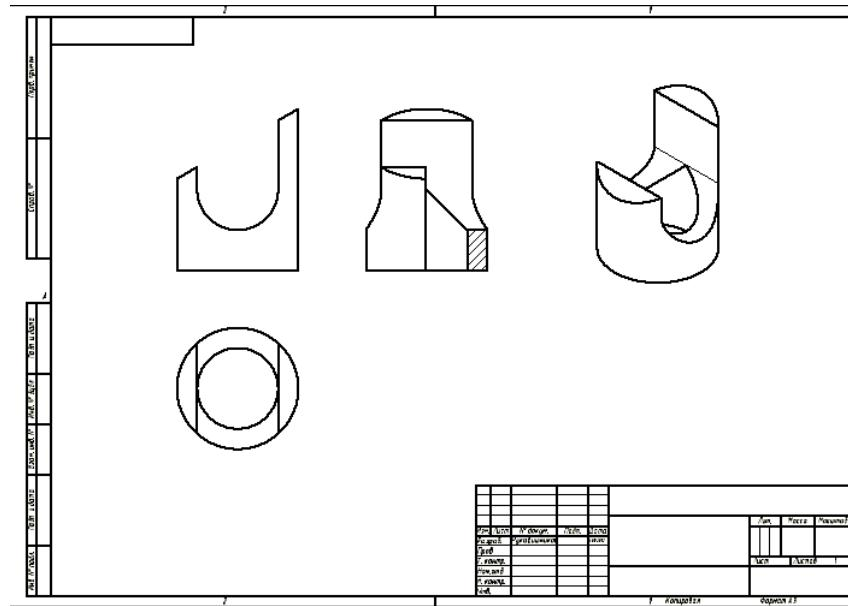
Рис. 7.36. Построение разреза на виде слева
