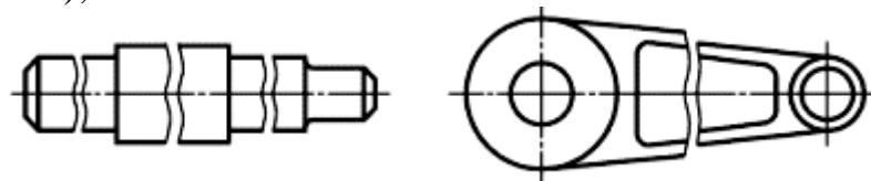
Рис. 5.13. Изображение вида предмета с разрывом сплошной волнистой линией
