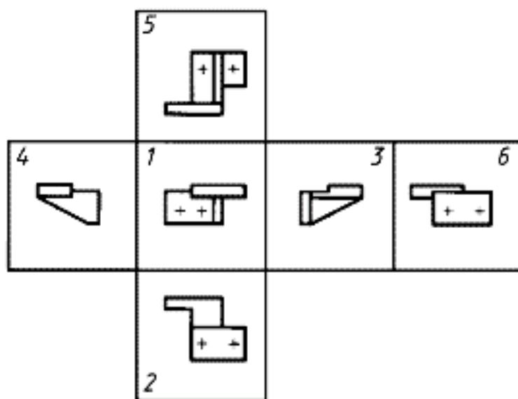
Рис. 1.2. Схема расположения основных видов
