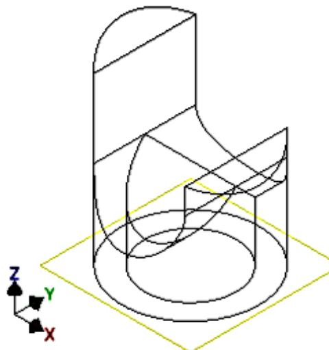
Рис.7.24. Построение выреза цилиндра
