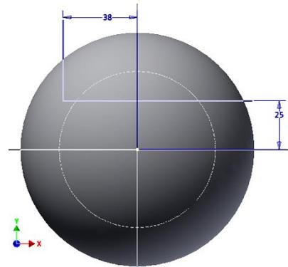
Рис. 7.56. Построение эскиза фронтального выреза шара
