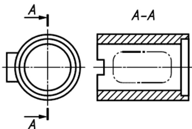
Рис. 5.16. Упрощенное изображение части предмета, находящейся между наблюдателем и секущей плоскостью
