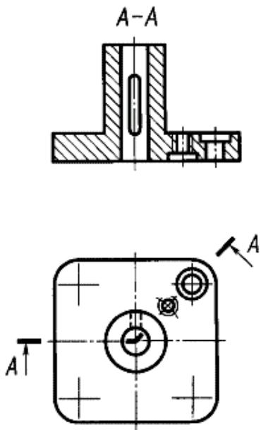
Рис. 2.9. Ломаный разрез
