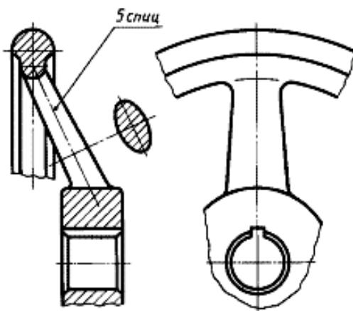
Рис. 5.3. Изображение части предмета с указанием количества и расположения его элементов
