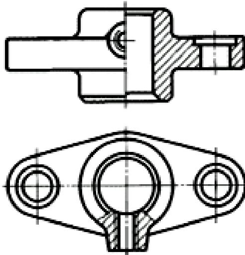
Рис. 2.14. Разрез предмета симметричной формы
