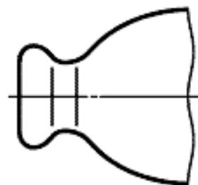
Рис. 5.8. Условное изображение плавного перехода от одной поверхности к другой на виде предмета
