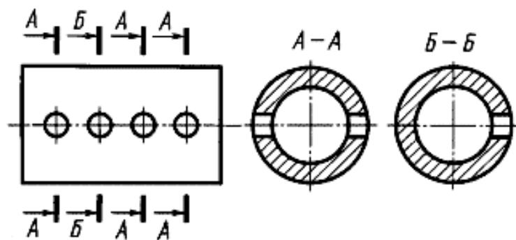
Рис. 3.11. Обозначение и изображение одинаковых сечений
