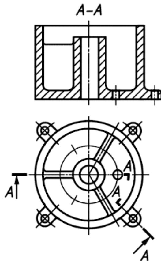
Рис. 5.17. Применение сложного разреза для сокращения количества изображений
