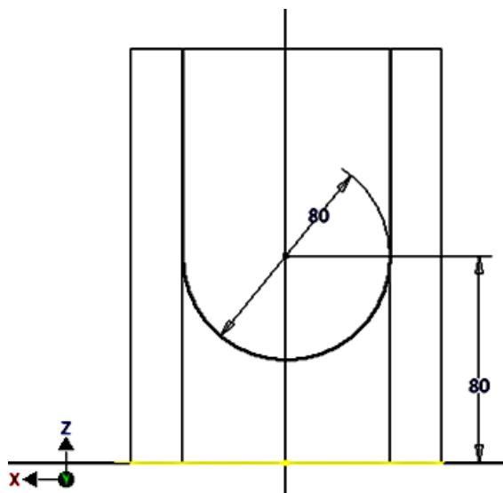
Рис. 7.15. Обрезка верхней части окружности
