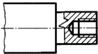
Рис. 2.7. Местный разрез выделен сплошной тонкой линией с изломом
