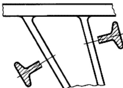
Рис. 3.14. Изображение нормальных поперечных сечений
