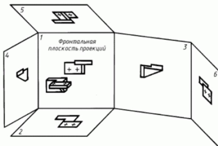
Рис. 1. Расположения основных видов на плоскостях проекций
