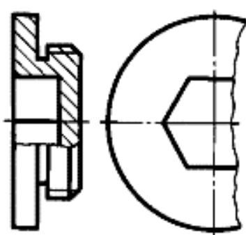
Рис. 2.13. Изображение разреза и неполного вида слева
