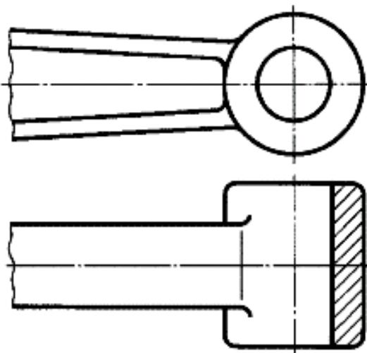
Рис. 2.15. Разделение разреза и вида штрихпунктирной тонкой линией
