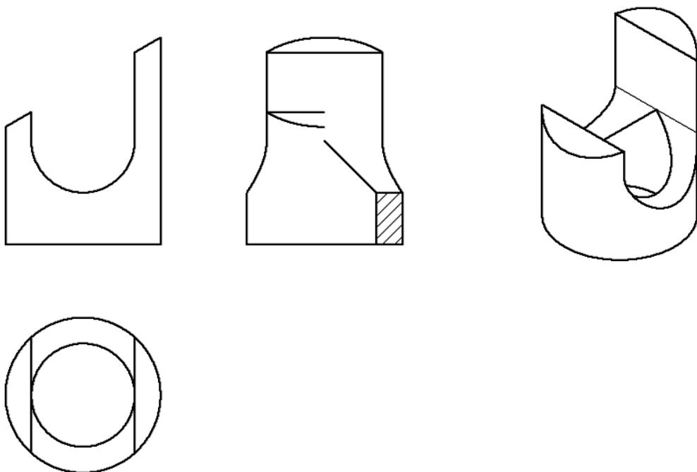
Рис. 7.38. Удаление остальных фрагментов линии разреза при помощи команды «Видимость»
