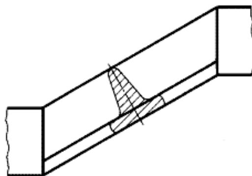
Рис. 3.4. Наложенное сечение, расположенное на виде предмета
