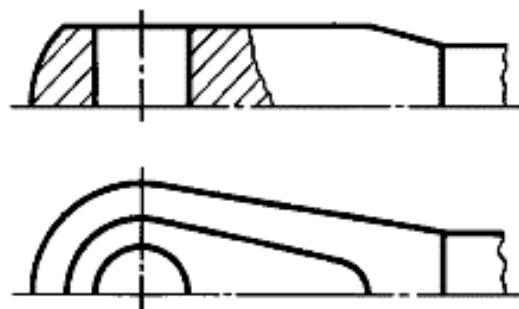
Рис. 5.5. Упрощенное изображение разреза на видах спереди и сверху
