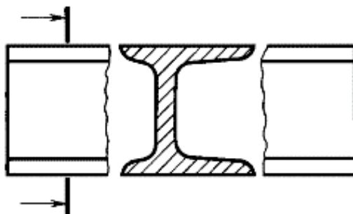
Рис. 3.8. Несимметричное сечение в разрыве
