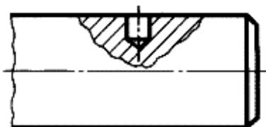
Рис. 2.6. Местный разрез выделен сплошной волнистой линией
