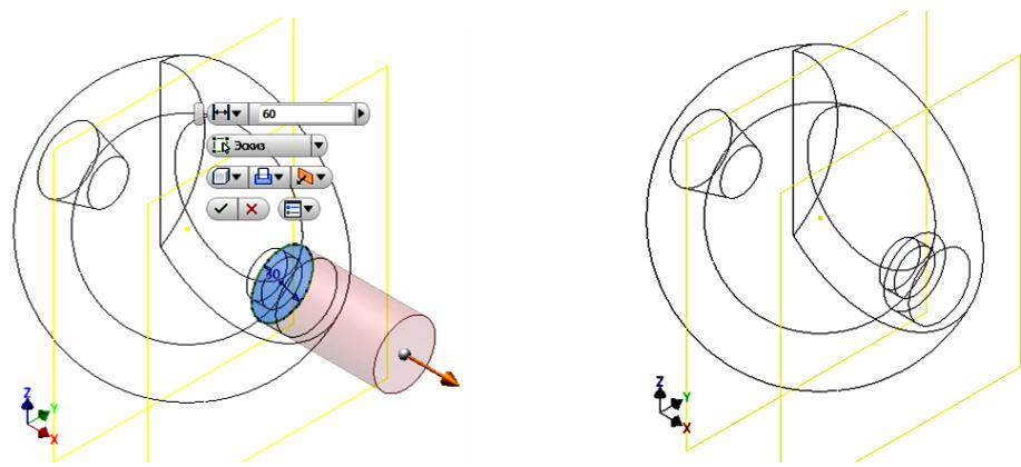
Рис. 7.67. Построение отверстия через команду «Выдавливание» в режиме удаления материала
