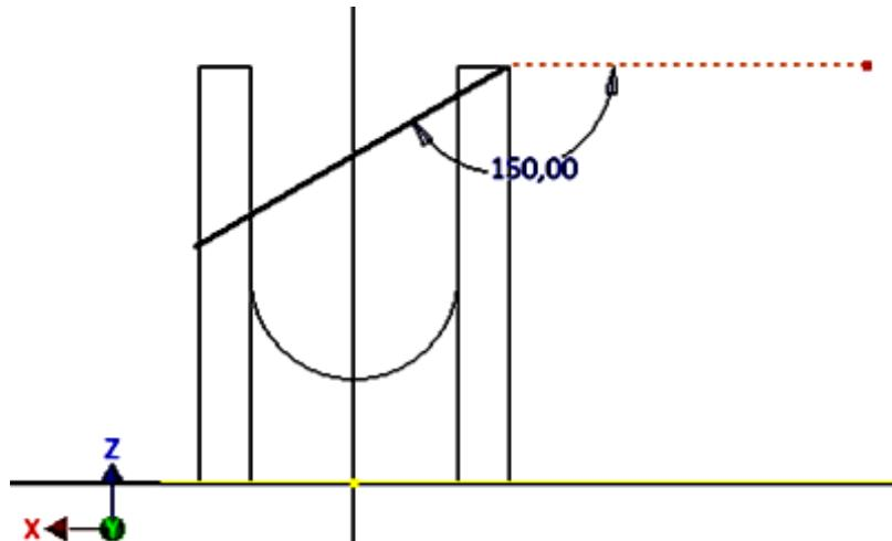
Рис. 7.21. Построение линии среза под углом  $150^\circ$
