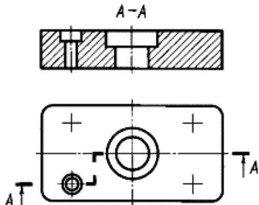
Рис. 2.8. Ступенчатый разрез
