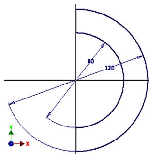
Рис. 7.51. Построение отрезков для удаления части геометрических элементов
