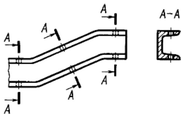
Рис. 3.13. Обозначение и изображение одинаковых сечений под различными углами
