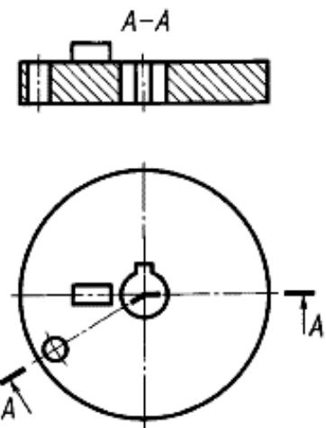
Рис. 2.10. Ломаный разрез
