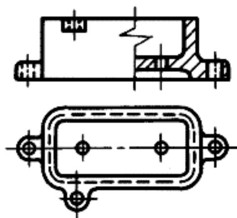
Рис. 2.12. Соединение части вида с разрезом, разделенных линией с изломом
