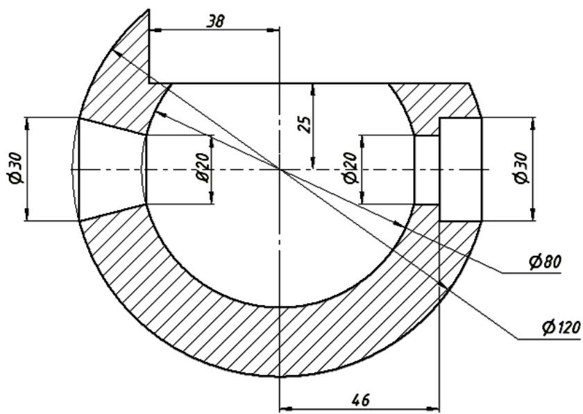
Рис. 7.47. Чертеж полого шара с отверстиями
