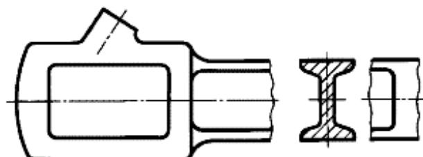
Рис. 3.5. Вынесенное сечение в разрыве между частями одного вида
