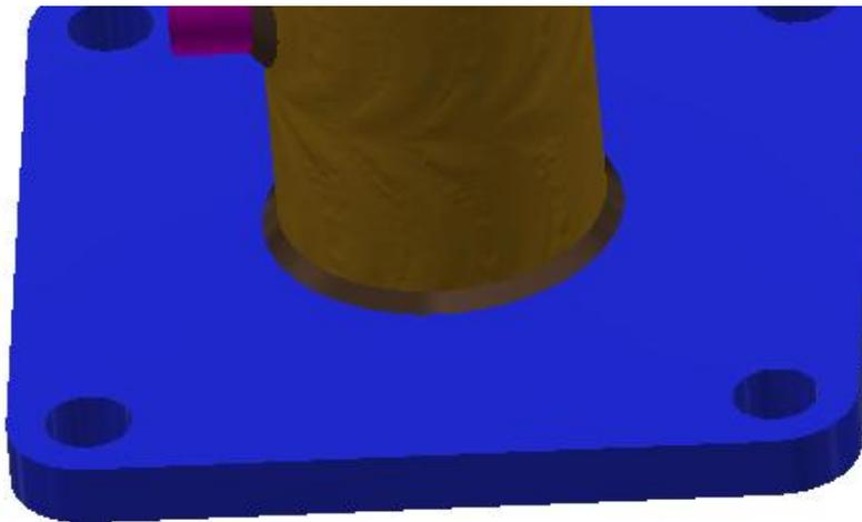
Рис. 22. Сварной шов соединения Стакана и Фланца нижнего
