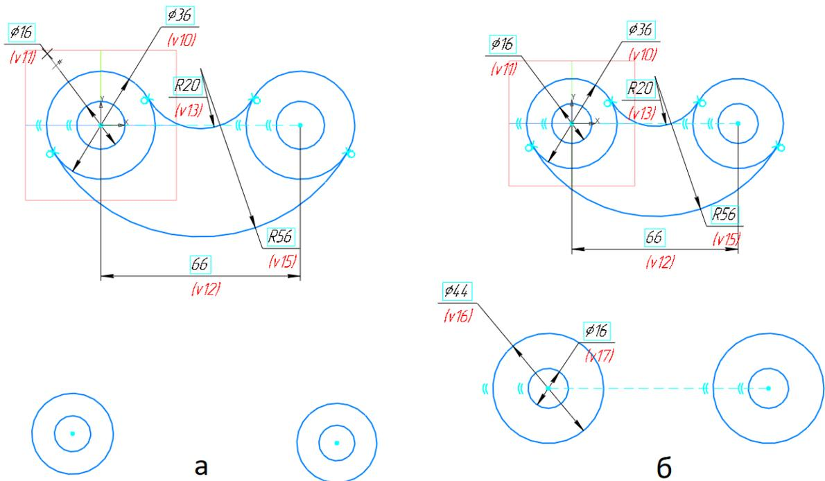
Рис. 11. Построение среднего сектора чертежа: а) построение четырех базовых окружностей б) нанесение размеров и ограничений
