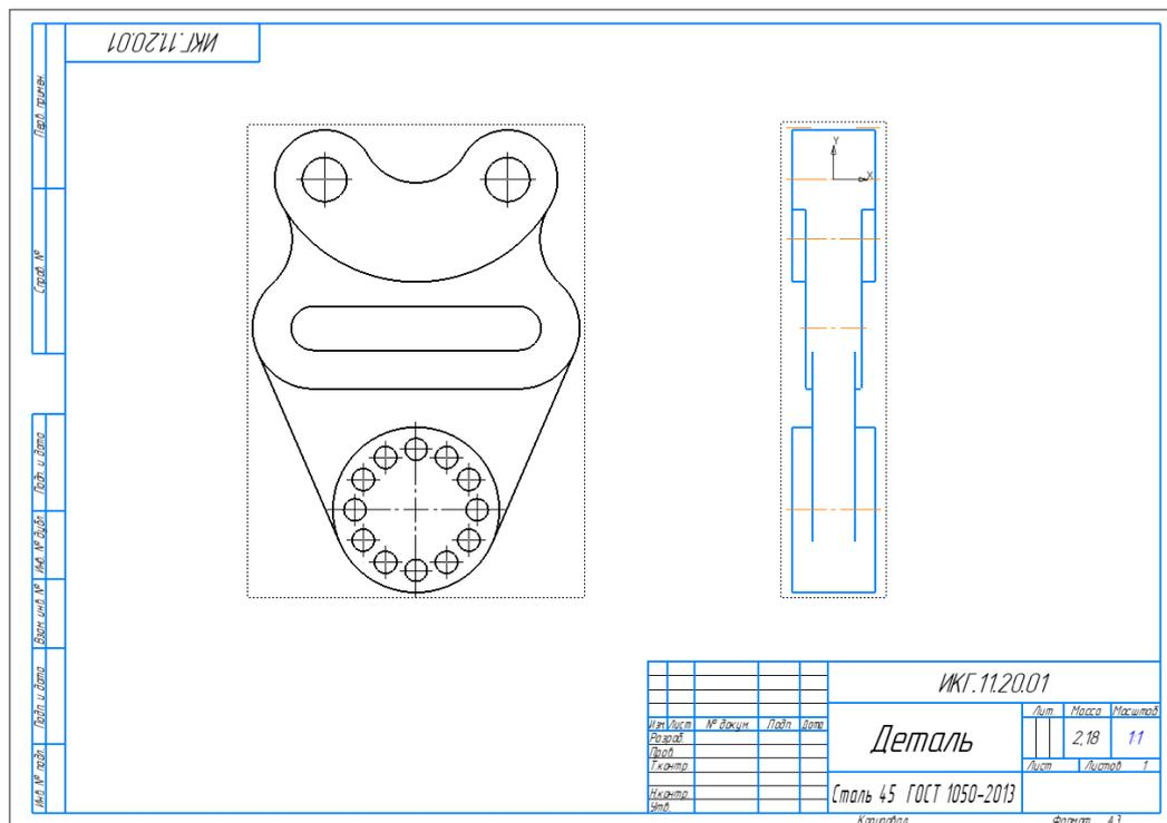
Рис. 34. Расположение основных видов детали
