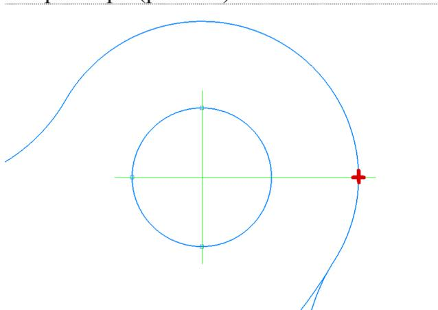
Рис. 37. Удлинение осевых линий.
