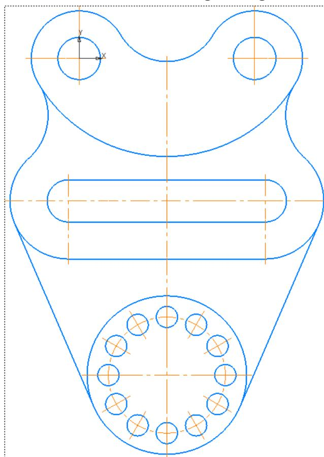
Рис. 38. Простановка осевых линий
