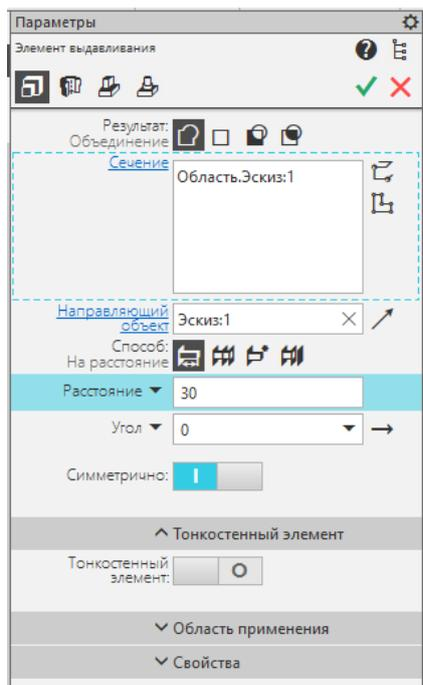
Рис. 27. Окно параметров команды «Элемент выдавливания»
