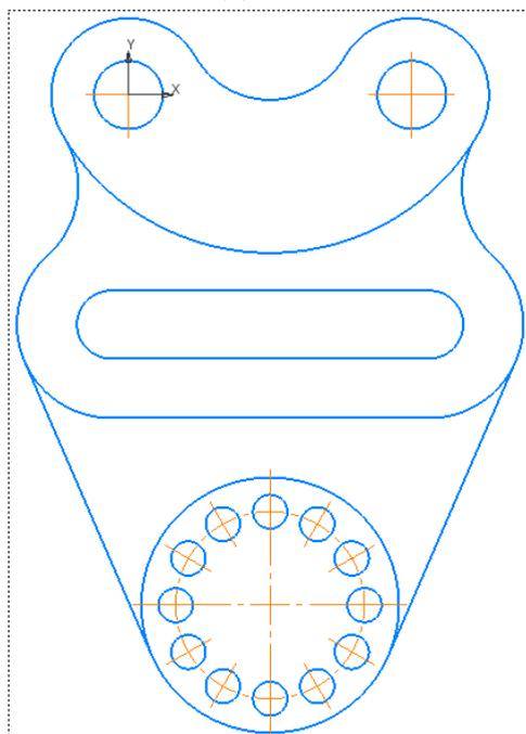
Рис. 36. Проставление осевых линий массива
