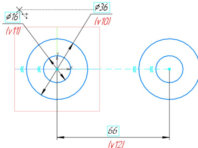
Рис. 7. Окружности, после простановки размера
