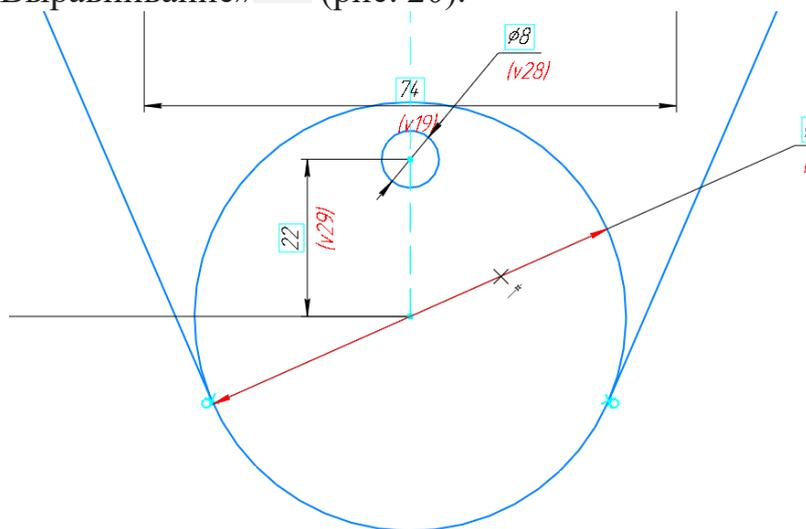
Рис. 20. Построение окружности массива
