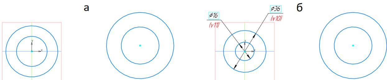
Рис. 4. Построение окружности: а) в глазомерном масштабе б) задание диаметров (параметров)
