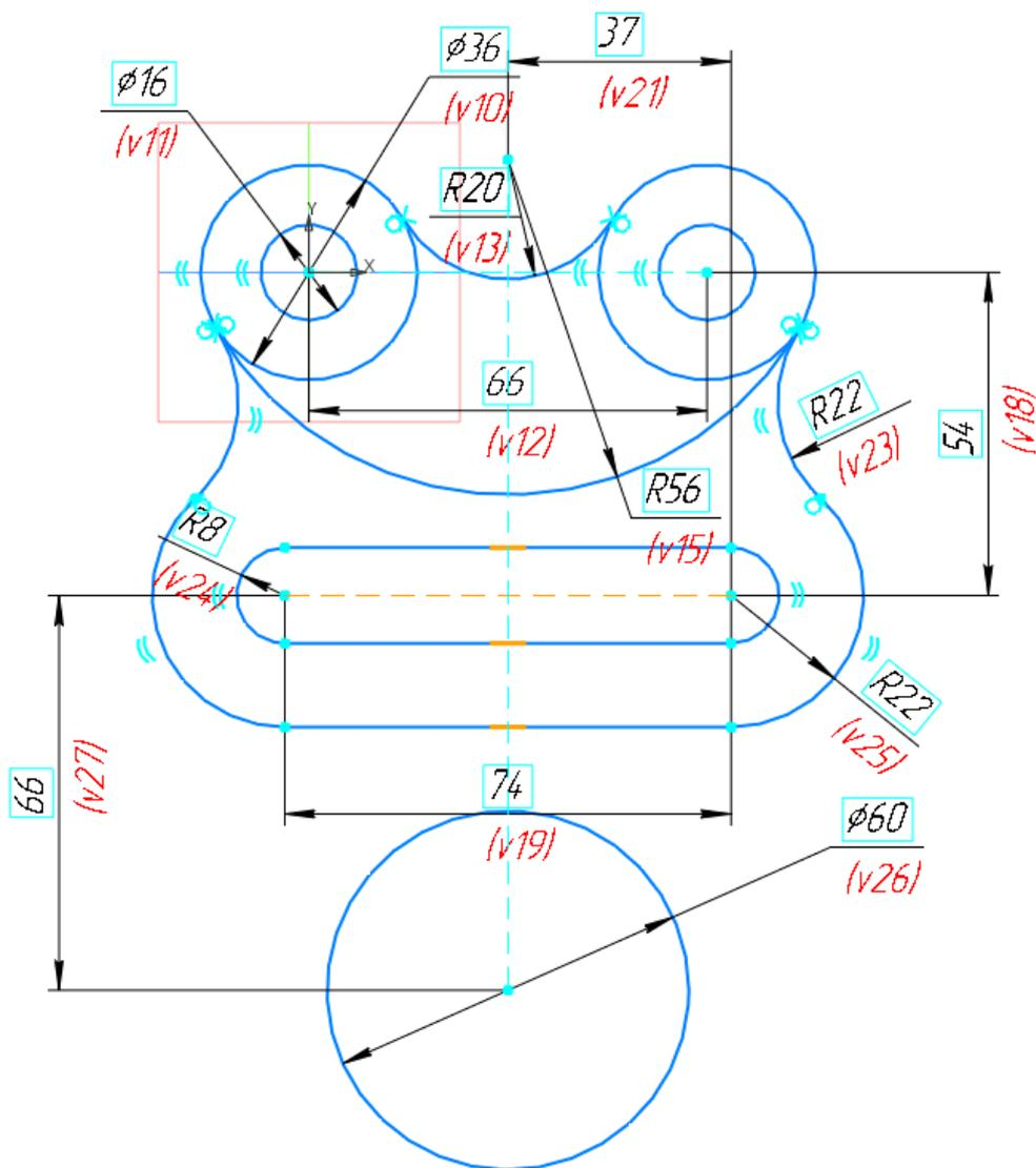
Рис. 18. Построение окружности  $\phi 60$  мм
