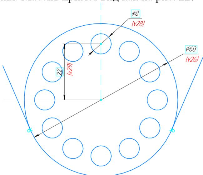
Рис. 22. Построение массива элементов
