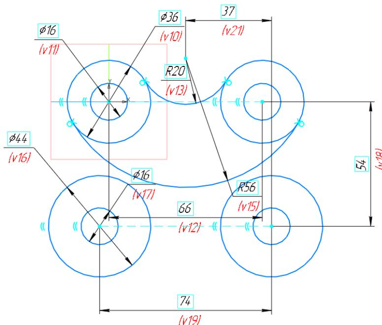
Рис. 14. Выравнивание окружностей относительно оси симметрии
