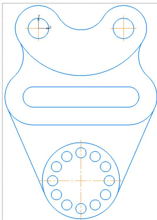
Рис. 35. Удаление лишних осевых линий
