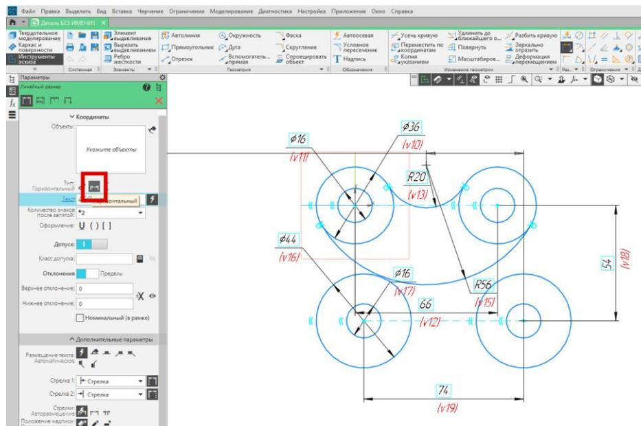
Рис. 13. Простановка горизонтального размера
