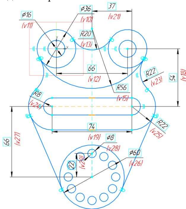
Рис. 23. Чертеж, после построения массива
