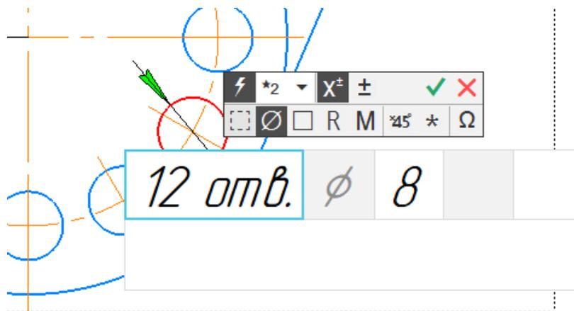
Рис. 39. Указания количества отверстий массива
