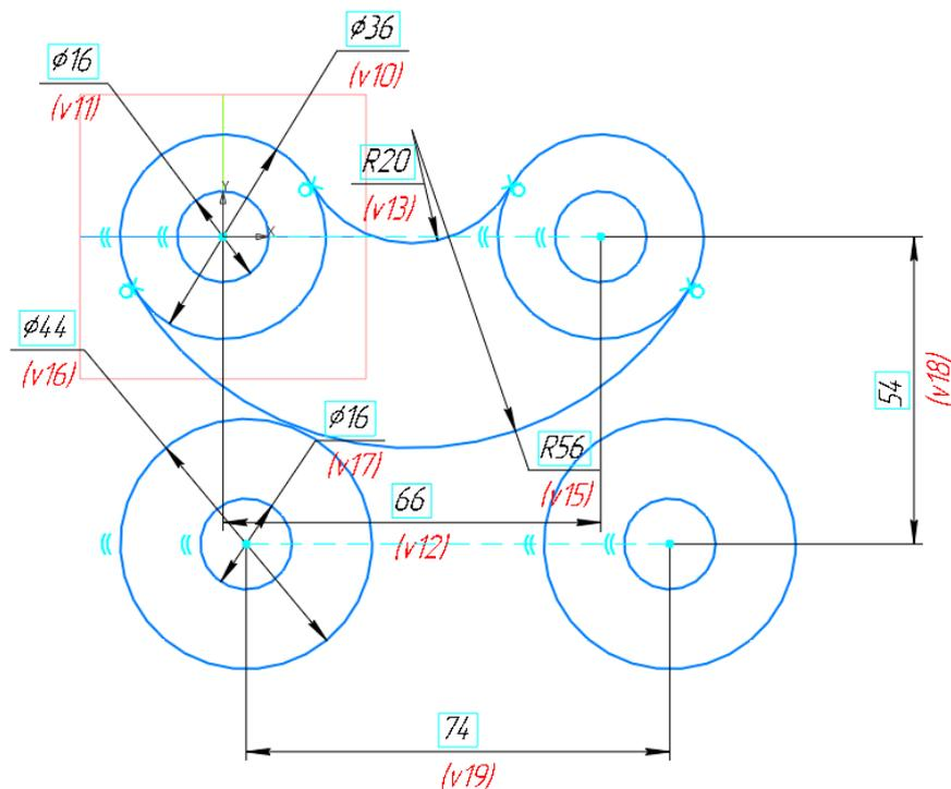
Рис. 12. Задание размеров положения геометрических элементов по вертикали и горизонтали
