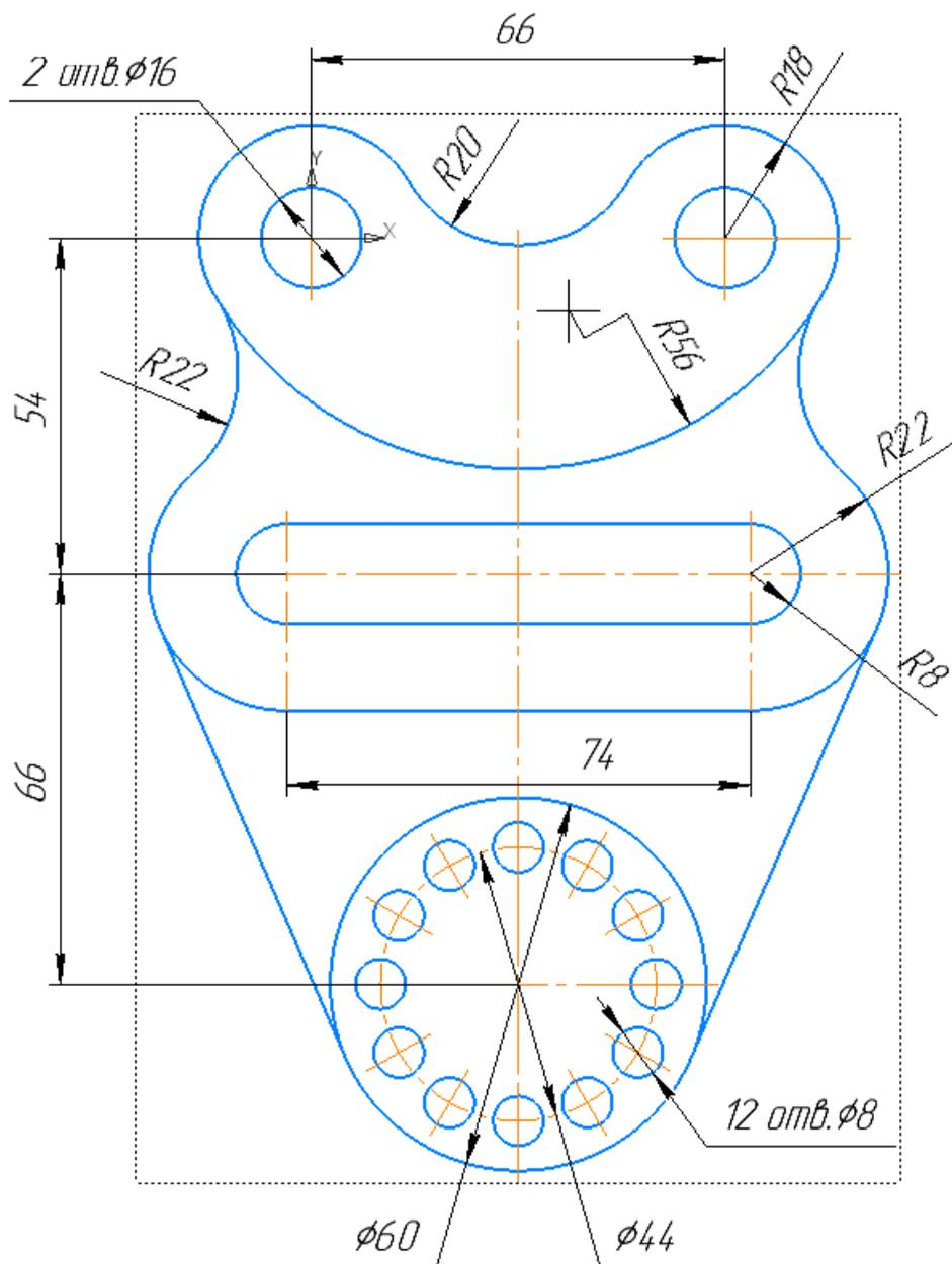
Рис. 40. Чертеж после нанесения размеров
