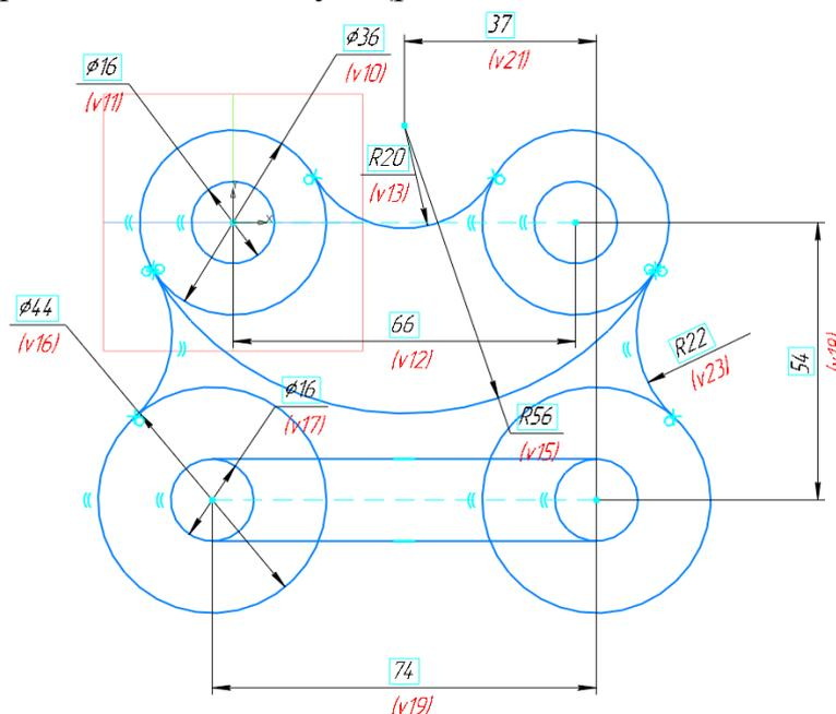
Рис. 16. Построение двух дуг сопряжения R22
