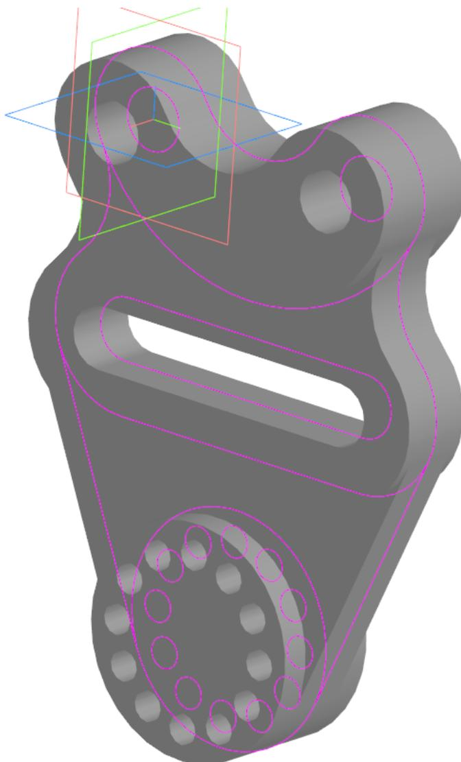
Рис. 29. Завершение построения детали
