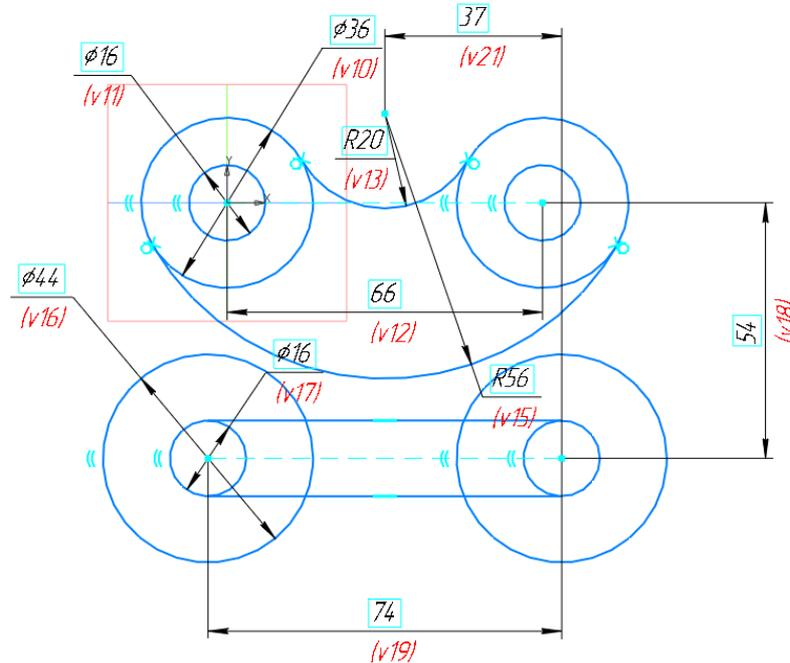
Рис. 15. Соединение внутренних окружностей отрезками прямых
