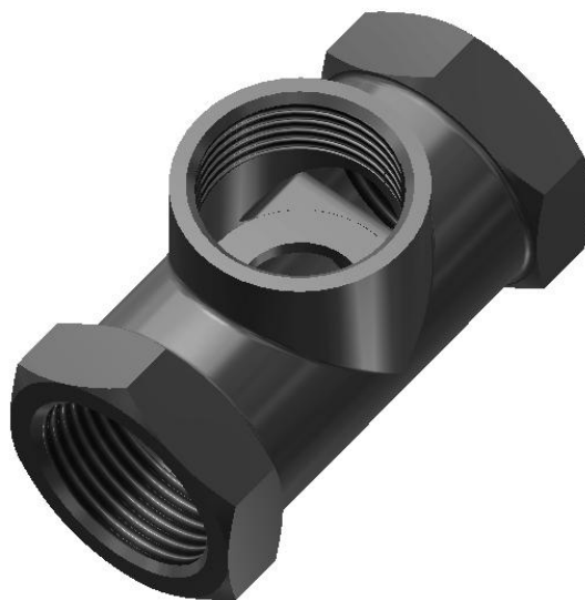
Рис. 3.61. Завершенная модель корпуса вентиля
