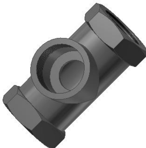
Рис. 3.45. Создание вертикального канала
