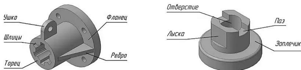
Рис. 2.5. Различные конструктивные элементы деталей
