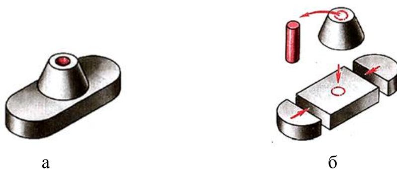
Рис. 3.1. Мысленное «расчленение» детали на геометрические формы: а) деталь; б) геометрические элементы детали
