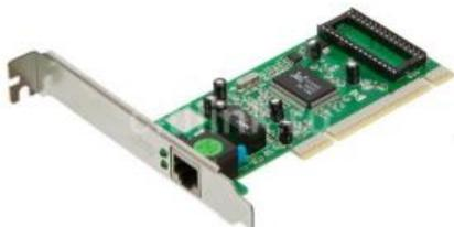
Рисунок 1. Внутренняя сетевая плата
