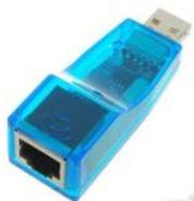
Рисунок 2. Внешняя сетевая плата
