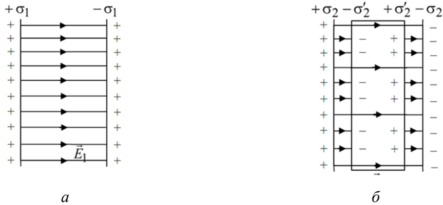
Рис. 14.3. К задаче 14-5: a – диэлектрик отсутствует; б – диэлектрик присутствует
